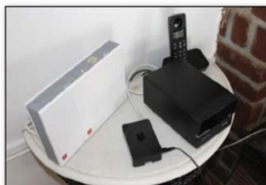
Commençons par brancher le Raspberry Pi sur votre routeur/box avec le câble Ethernet. Branchons aussi l'alimentation. Au bout de quelques
