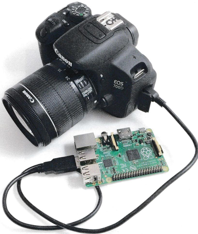
La connexion entre l'appareil photo et la Raspberry Pi se fait à l'aide d'un simple câble USB. Ceci est une fonction standard des appareils qui ne risque pas d'endommager quoi que ce soit. Ici, j'ai fait mes tests avec un Canon EOS 700D, mais plus de 1200 modèles sont compatibles avec l'outil gPhoto, y compris des APN compacts, des modèles d'entrée de gamme ou des appareils ayant un bon nombre d'années.
