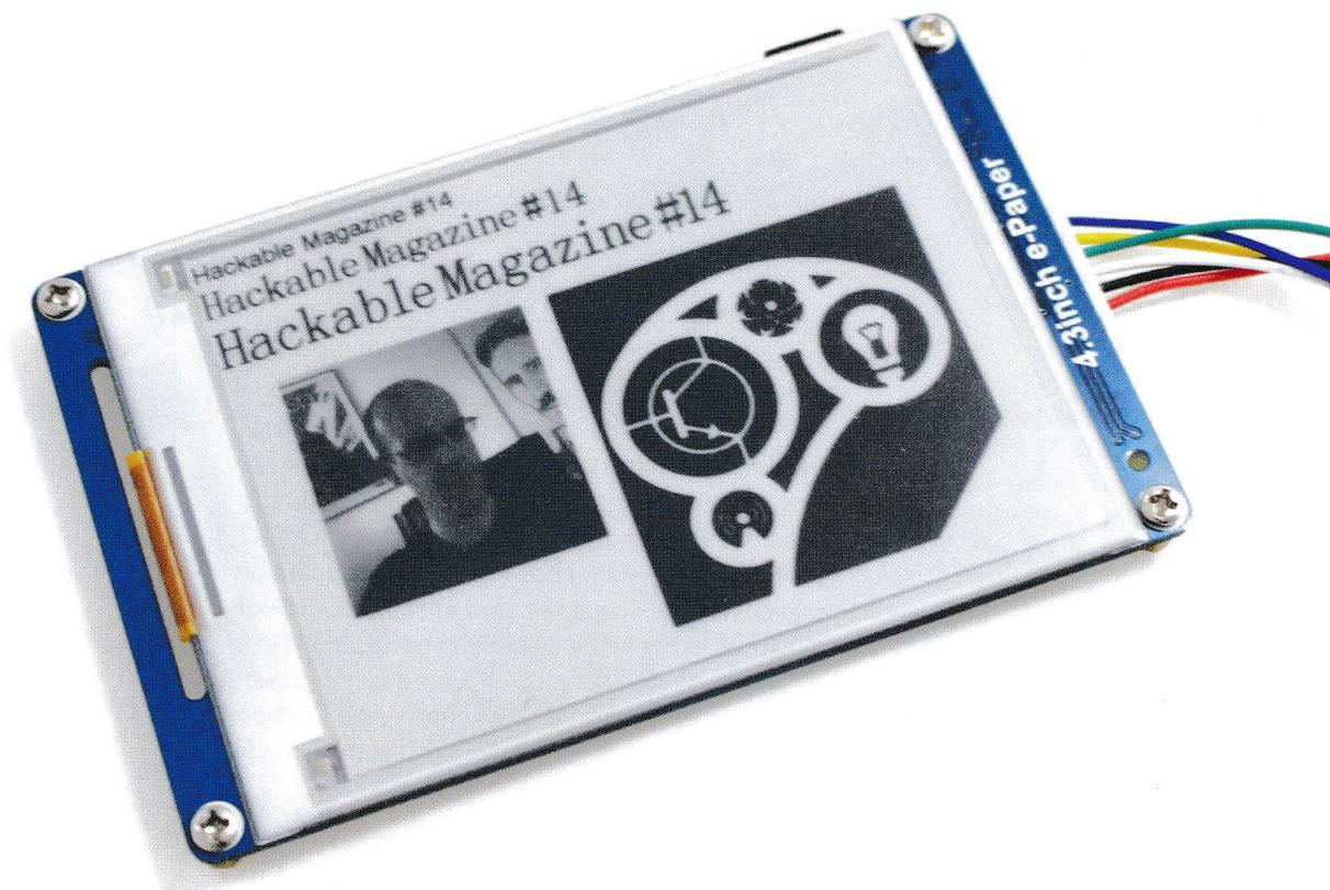
Le module d'affichage se présente sous la forme d'un circuit imprimé de 75 x 118 mm où un écran de 4,3 pouces d'une résolution de 800x600 pixels occupe la majeure partie de la surface. Largement suffisant pour envisager de nombreuses applications...
