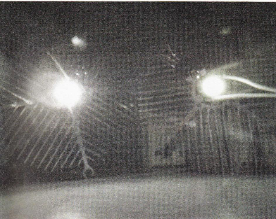
*Cette image a été capturée avec le module NoIR équipé d'un filtre passe-haut et présente à gauche une led de 4W émettant sur une longueur d'onde de 850nm et à droite une led de 1W sur 940nm. On constate clairement que la caméra est sensible aux deux longueurs d'ondes, contrairement à certaines netcams destinées à la vidéosurveillance.*
