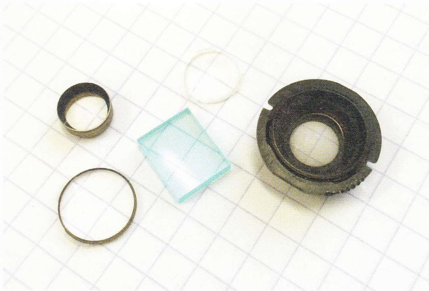
*Le démontage d'un appareil photo numérique permet de récupérer le miroir chaud intégré, mais également quelques lentilles pouvant éventuellement être utilisées avec le module caméra en bricolant un peu (en particulier si, comme moi, vous avez endommagé l'objectif en essayant d'ajuster la mise au point... Bravo Denis ! Clap, clap, clap !).*
