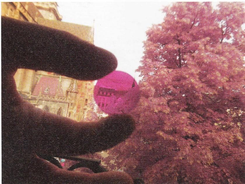
Ce filtre Edmund Optics est opaque pour tout rayonnement inférieur à 700 nm. Il apparaît donc noir pour nos yeux ou une caméra standard, mais transparent pour le module NoIR. Les couleurs et en particulier celles du filtre découlent de l'ajustement automatique de la caméra. Une fois le filtre couvrant totalement l'optique, le rendu s'équilibrera naturellement et l'image ne sera plus rosâtre.
