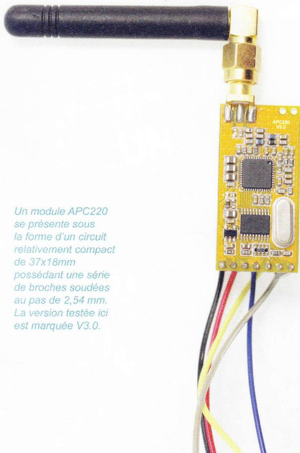
*Un module APC220 se présente sous la forme d'un circuit relativement compact de 37x18mm possédant une série de broches soudées au pas de 2,54 mm. La version testée ici est marquée V3.0.*
