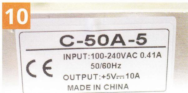
10 ampères en 5 volts, voilà ce qu'est en mesure de fournir l'alimentation utilisée. C'est plus qu'il n'en faut, mais le modèle immédiatement inférieur ne propose qu'un courant de 2A. De plus, une telle alimentation permettra également de fournir le courant nécessaire pour un montage équivalent, mais en version 120 cm (réglette à 19,95€).
