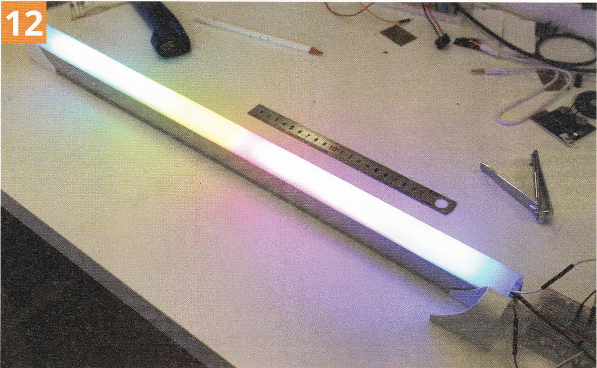
*Un premier essai avec un croquis maison affichant un dégradé coloré arc-en-ciel permet de constater le rendu. Ce n'est pas très visible en photo, mais la luminosité globale est aussi importante que les leds blanches originales.*
