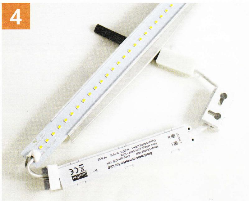
Le circuit supportant les leds est lui aussi glissé dans des rails du support en aluminium. Après démontage du bloc d'alimentation et des différents connecteurs, l'ensemble peut être désossé assez aisément. Le circuit de leds n'est pas collé contrairement à l'alimentation qui demande un peu de « persuasion mécanique manuelle ».
