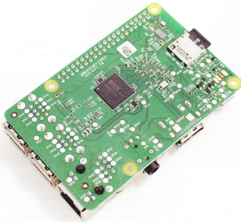
*Le dessous de la carte accueille la mémoire d'1 Go exactement comme la RPi 2 alors que le modèle B+ voyait ce composant placé sur le SoC. Notez également l'emplacement à souder près du trou de fixation en haut à gauche correspondant au signal « RUN » permettant de réveiller le système. Les précédents modèles de Raspberry Pi voyaient cet emplacement placé à côté du connecteur pour l'écran DSI.*
