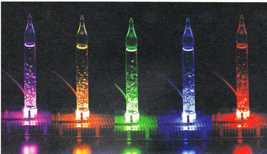
En ajoutant simplement une led WS2812b à la base de l'ampoule de dichlorométhane, non seulement on obtient un effet très intéressant, mais en plus on augmente la température et donc l'intensité de l'ébullition. Ajouter un contrôle de couleur par la carte Arduino et vous obtenez une base très originale pour un effet lumineux.
