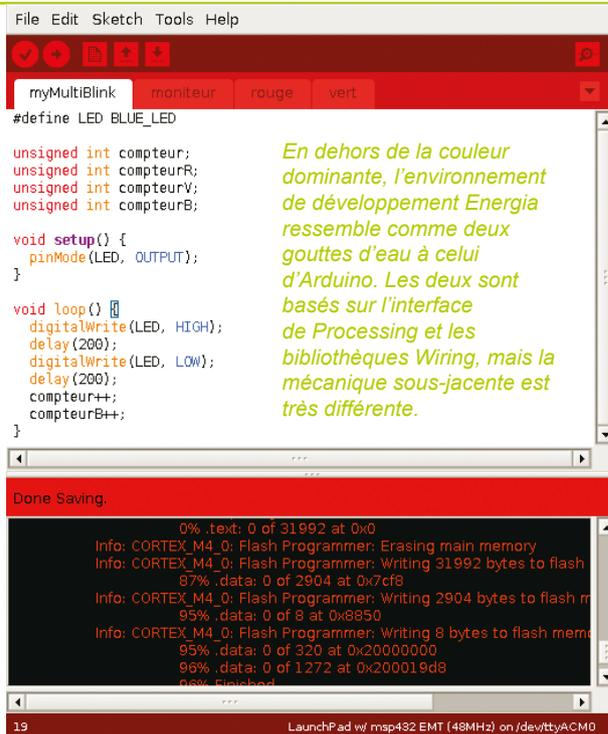
*En dehors de la couleur dominante, l'environnement de développement Energia ressemble comme deux gouttes d'eau à celui d'Arduino. Les deux sont basés sur l'interface de Processing et les bibliothèques Wiring, mais la mécanique sous-jacente est très différente.*
