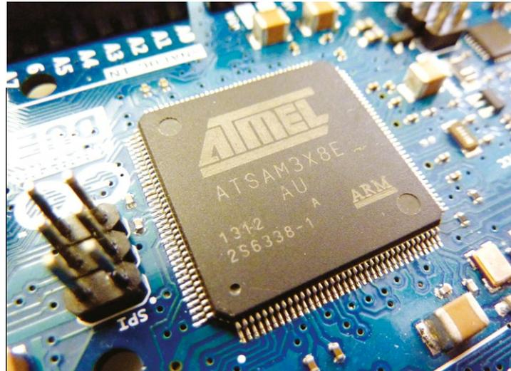
*Les cartes Arduino Due n'utilisent pas de microcontrôleurs AVR, mais un ATSAM3 totalement différent. Au plus bas niveau, cette différence se fait grandement ressentir, mais en restant dans les facilités offertes par l'environnement Arduino la transition est aisée. Pour la plupart des croquis, aucune modification n'est nécessaire. C'est là l'un des nombreux avantages du « langage Arduino », mais cela se fait au détriment de la pleine maîtrise de la plateforme.*
