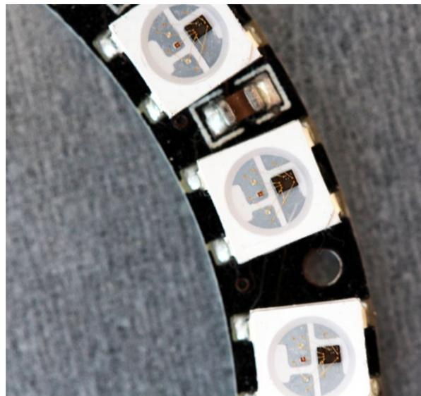
Gros plan sur une partie du NeoPixel Ring. On distingue un des condensateurs de découplage à proximité d'une des leds. Il faudra cependant toujours ajouter un autre condensateur entre la masse et Vcc au niveau de l'alimentation. Précisons qu'il est hors de question d'alimenter 24 WS2812B avec une carte Arduino.
