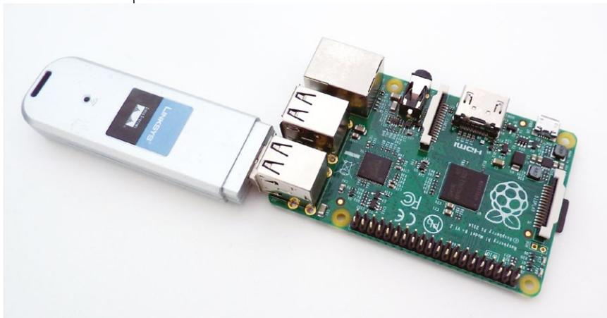
*Une Raspberry Pi B ou B+ et un adaptateur Wifi USB, il n'en faut pas plus pour créer un point d'accès permettant bon nombre d'applications. Il existe des adaptateurs USB bien plus compacts que le Cisco/Linksys WUSB54GC un peu ancien (2008) présenté ici. Il présentait l'avantage, à l'époque, d'être une valeur sûre en termes de compatibilité GNU/Linux et de fonctionnalité (mode monitor), j'en avais donc acheté 3...*
