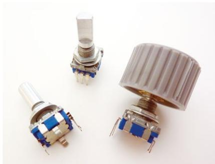
Les encodeurs rotatifs sont des éléments mécaniques ne fournissant ni position ni valeur. On ne peut donc pas simplement lire l'état des broches à un instant  $t$  pour connaître la position courante. Il faut plutôt les voir comme des incrémenteurs/décrémenteurs. Schématiquement, ils se composent de deux interrupteurs qui, en fonction de leurs états successifs, permettent de connaître le sens de rotation et le nombre de pas.
