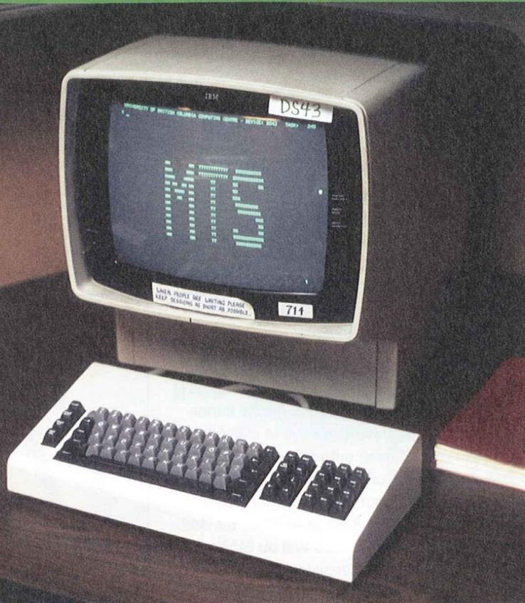
Un terminal IBM 3277 model 2 de 1972, un classique représentant de la gamme 3270 utilisé avec les mainframes IBM comme le classique System/360 (source par Gavin Eadie - licence CC BY-SA 1.0 via Wikimedia Commons).
