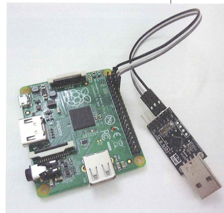
Un adaptateur USB/série en 3,3V et trois malheureux câbles pour connecter le tout. Il n'en faut pas davantage pour pouvoir utiliser une Raspberry Pi A+ sans écran et sans réseau.
