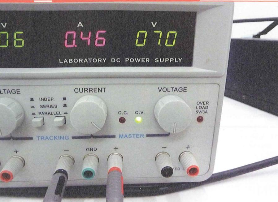
L'alimentation de laboratoire fournissant le courant au module d'affichage avec un texte standard n'utilisant pas tous les segments. Nous avons là un courant de 460mA en 7V, soit 3,2W. Combien si vous utilisez 4 modules chaînés ? Il suffit de multiplier, presque 13 watts !
