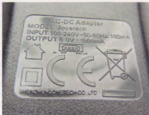
L'alimentation du « chargeur » est un bloc secteur relativement standard équipé d'un port USB pouvant fournir 500 mA sous 5 volts.
