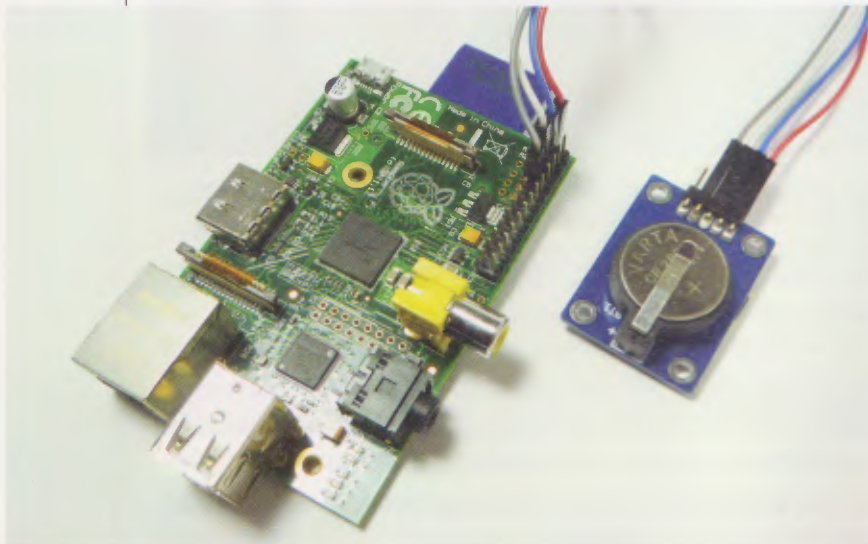
Notre Raspberry Pi connectée au module RTC alimenté par une pile bouton de type CR2032, suffisante pour faire fonctionner l'horloge durant des mois sinon des années et ainsi tenir l'heure à jour même la Raspberry Pi éteinte.
