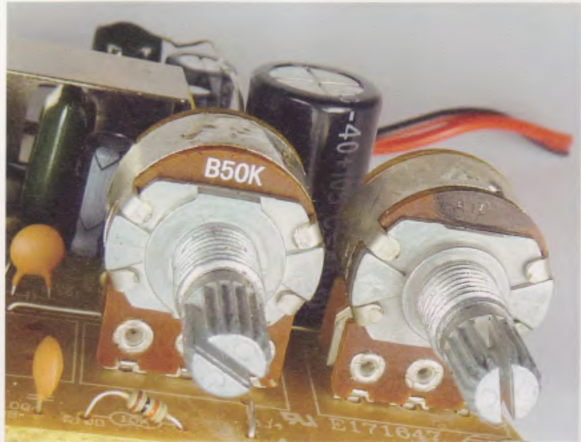
Les potentiomètres rotatifs, comme il en existe pour contrôler le volume d'enceintes multimédia par exemple, sont des résistances variables. En tournant l'axe central, on déplace un point de contact sur une surface. Comme la résistance est fonction de la distance, la valeur de cette résistance varie.
