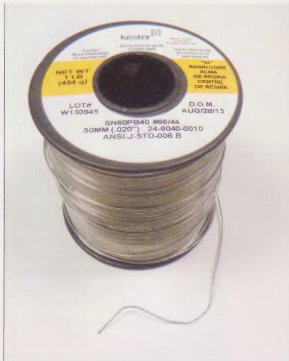
L'étain de bonne qualité, avec la station et la panne est l'un des trois éléments qui font le succès d'une soudure réussie. Ici de l'étain 60% étain / 40% plomb avec un coeur résine (flux décapant) de 0,5 mm de diamètre, de chez Kester.
