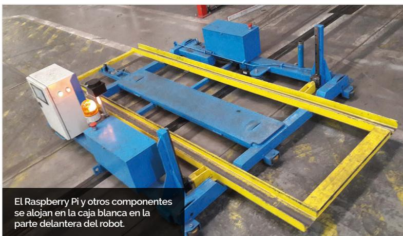
El Raspberry Pi y otros componentes se alojan en la caja blanca en la parte delantera del robot.
