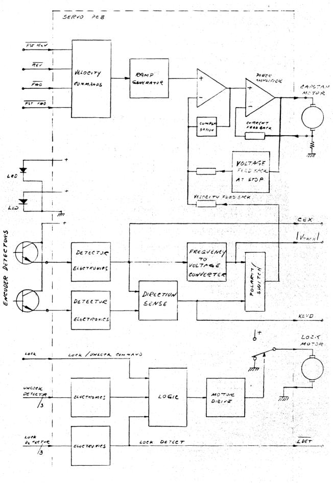
BLOCK DIAGRAM SERVO PCB
