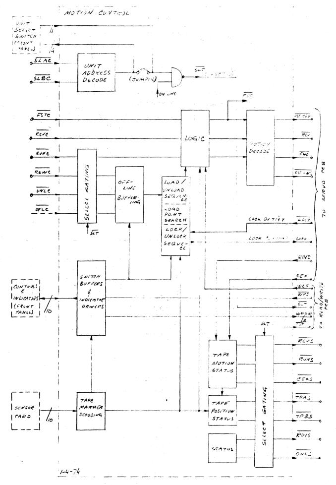
BLOCK DIAGRAM, MOTION CONTROL PCB
