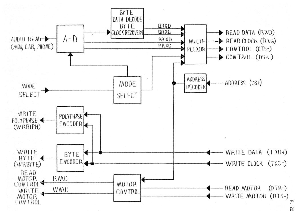
FIG 1D. CASSETTE INTERFACE BLOCK DIAGRAM
