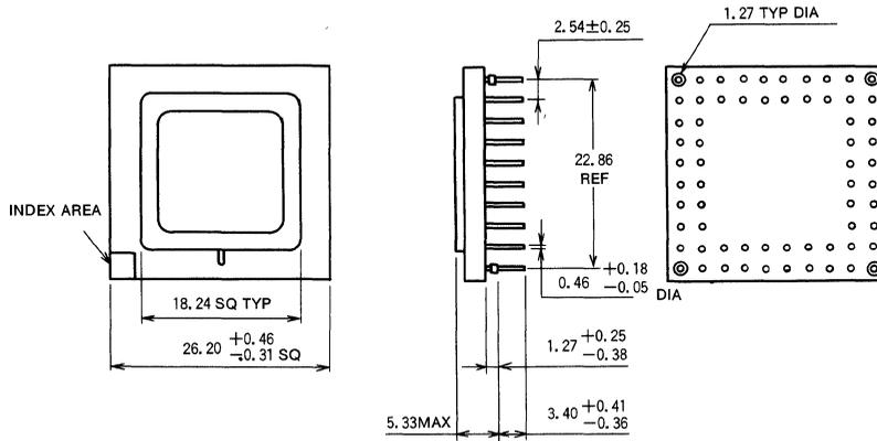
**TYPE 68POX-A 68-PIN MOLDED PLASTIC LEADED CHIP CARRIER (G<sub>MICRO</sub><sup>TM</sup>)**
