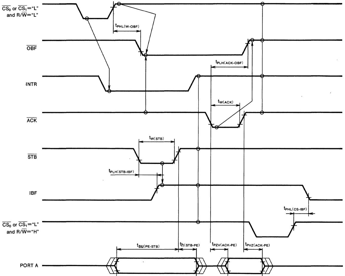
Note 5 :  $\overline{INTR} = \overline{IBF} \cdot \overline{MASK} \cdot \overline{STB} \cdot \overline{CS}_0$  or  $\overline{CS}_1 + \overline{OBF} \cdot \overline{MASK} \cdot \overline{ACK} \cdot R/W$
