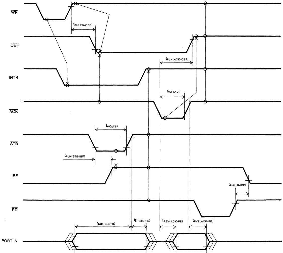
Note 13  $INTR = IBF \cdot \overline{MASK} \cdot \overline{STB} \cdot \overline{RD} + OBF \cdot \overline{MASK} \cdot \overline{ACK} \cdot \overline{WR}$
