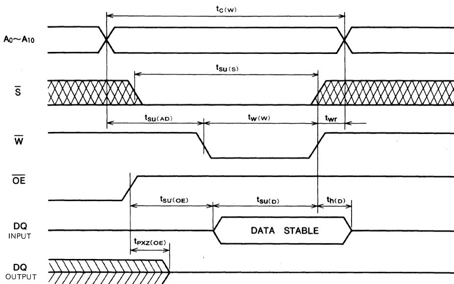
(b) WRITE CYCLE 2 ( $\overline{S}$  CONTROL MODE)
