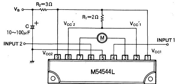
2) MOTOR SPEED CONTROL BY THE  $V_{cc}'$
