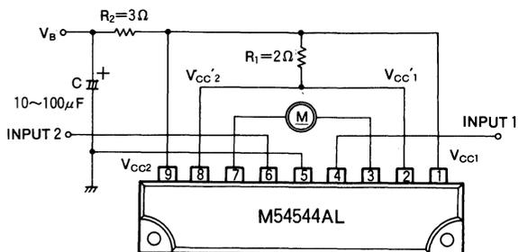
2) MOTOR SPEED CONTROL BY THE  $V_{CC}'$
