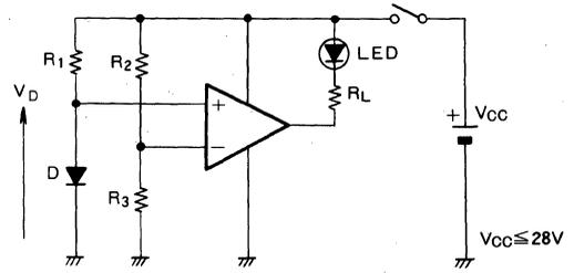
$$V_D < V_{CC} \cdot \frac{R_3}{R_2 + R_3} : \text{LED} \rightarrow \text{ON}$$
