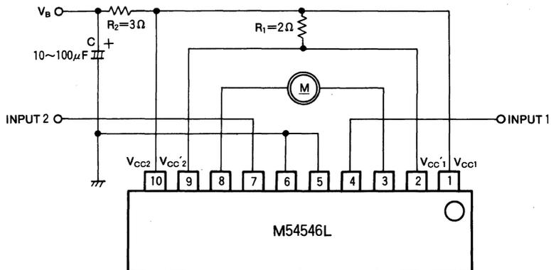
2) MOTOR SPEED CONTROL BY THE  $V_{CC}'$
