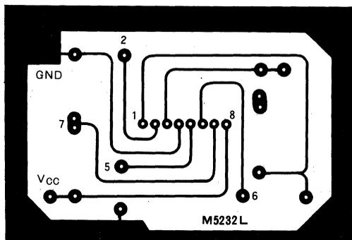
**PCB DIAGRAM (COPPER FOIL SIDE)
