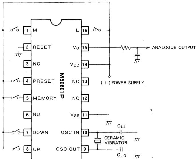
**ELECTRONIC VOLUME CONTROL CMOS 5-BIT D/A CONVERTER**
