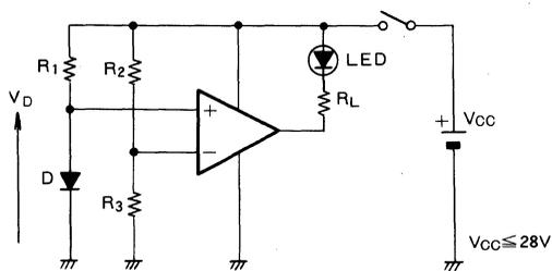
$$V_D < V_{CC} \cdot \frac{R_3}{R_2 + R_3} : \text{LED} \rightarrow \text{ON}$$
