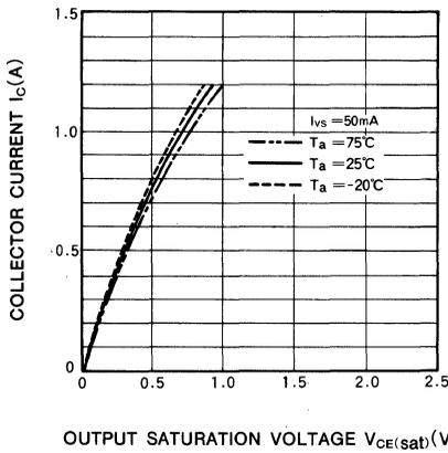
MAGNET RELAY DRIVER OUTPUT SATURATION CHARACTERISTICS
