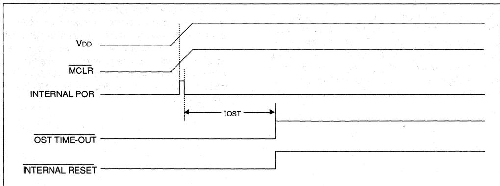
FIGURE 13.1.7 - USING ON-CHIP POR (SLOW VDD RISE TIME)
