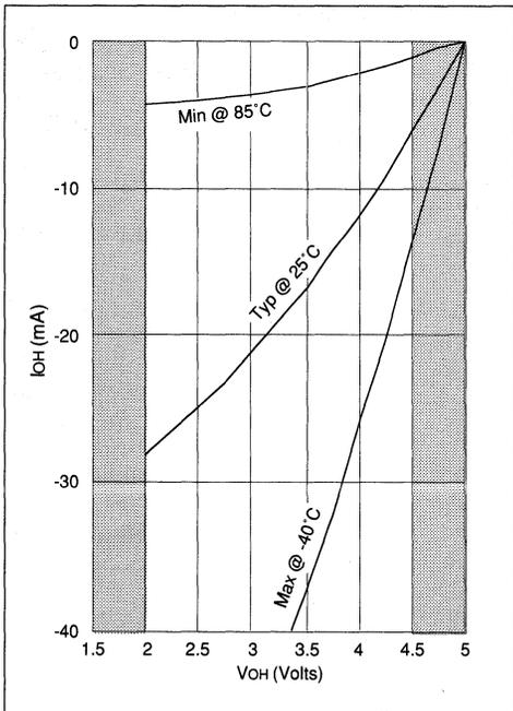
**FIGURE 18.0.20 - I<sub>OH</sub> vs V<sub>OH</sub>, V<sub>DD</sub> = 5V**
