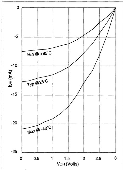
FIGURE 9.0.19 - I<sub>OH</sub> vs V<sub>OH</sub>, V<sub>DD</sub> = 5V
