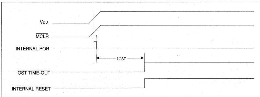
FIGURE 13.1.7 - USING ON-CHIP POR (SLOW V<sub>DD</sub> RISE TIME)
