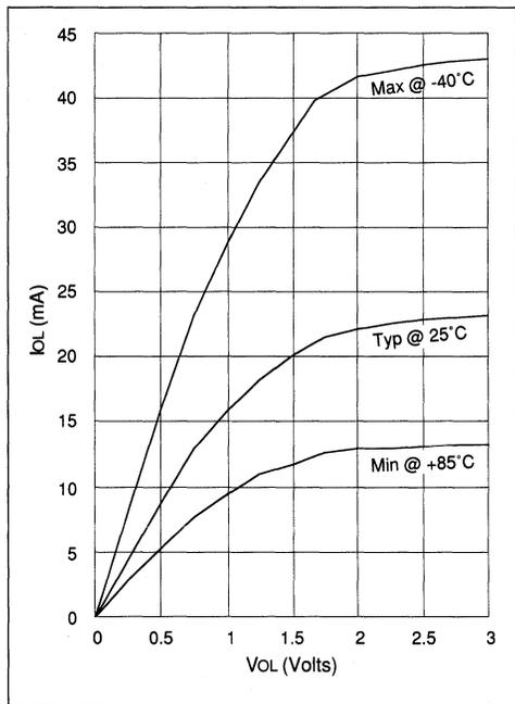
FIGURE 9.0.21 - I<sub>OL</sub> vs V<sub>OL</sub>, V<sub>DD</sub> = 5V
