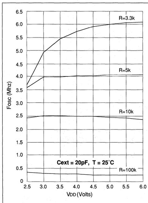
**FIGURE 18.0.3 - TYPICAL RC OSCILLATOR
