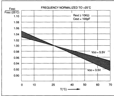
**FIGURE 9.0.2 - TYPICAL RC OSCILLATOR
