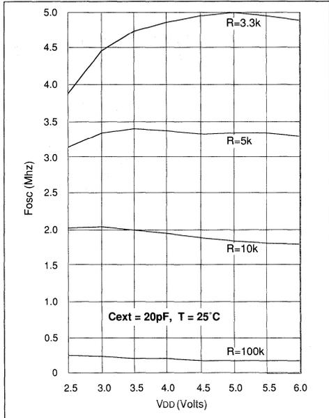
**FIGURE 9.0.3 - TYPICAL RC OSCILLATOR
