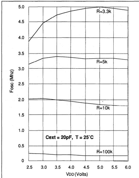
FIGURE 18.0.3 - TYPICAL RC OSCILLATOR FREQUENCY vs VDD
