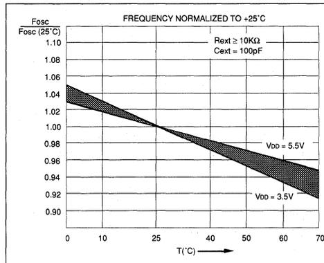
**FIGURE 18.0.2 - TYPICAL RC OSCILLATOR
