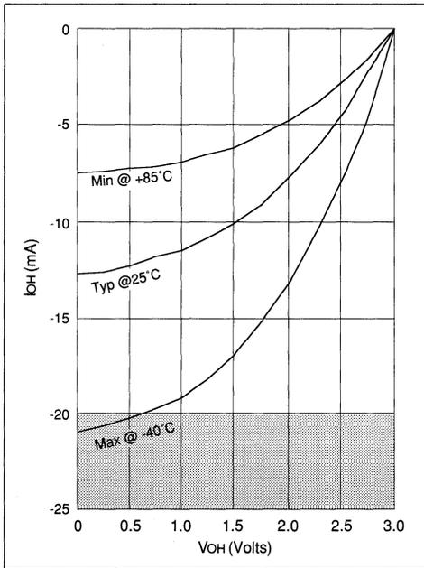
FIGURE 18.0.17 - I<sub>OH</sub> vs V<sub>OH</sub>, V<sub>DD</sub> = 5V
