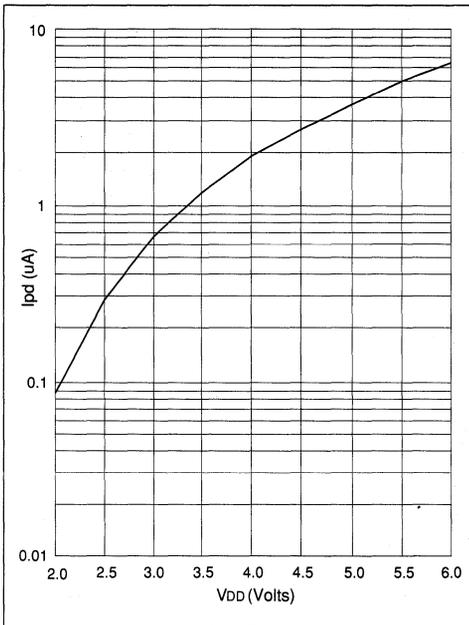
**FIGURE 18.0.6 - MAXIMUM IPD vs V<sub>DD</sub> WATCHDOG TIMER ENABLED**
