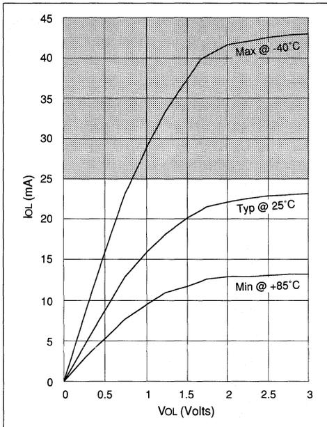
FIGURE 18.0.19 - I<sub>OL</sub> vs V<sub>OL</sub>, V<sub>DD</sub> = 5V
