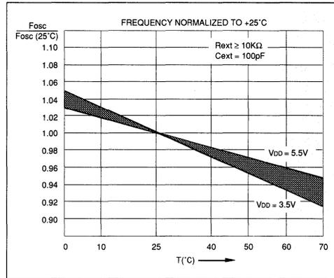
FIGURE 18.0.2 - TYPICAL RC OSCILLATOR FREQUENCY vs VDD
