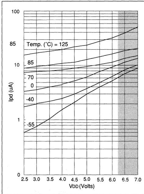
**FIGURE 18.0.8 - MAXIMUM I<sub>pd</sub> vs V<sub>DD</sub>
