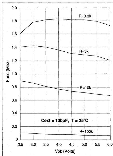
**FIGURE 18.0.4 - TYPICAL RC OSCILLATOR FREQUENCY vs V<sub>DD</sub>**
