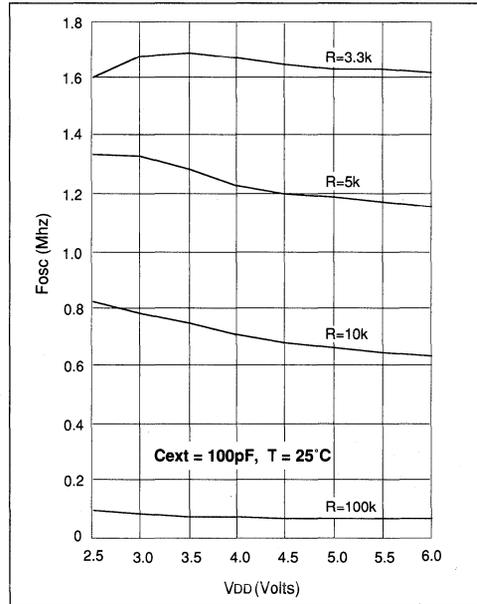
**FIGURE 18.0.4 - TYPICAL RC OSCILLATOR FREQUENCY vs V<sub>DD</sub>**
