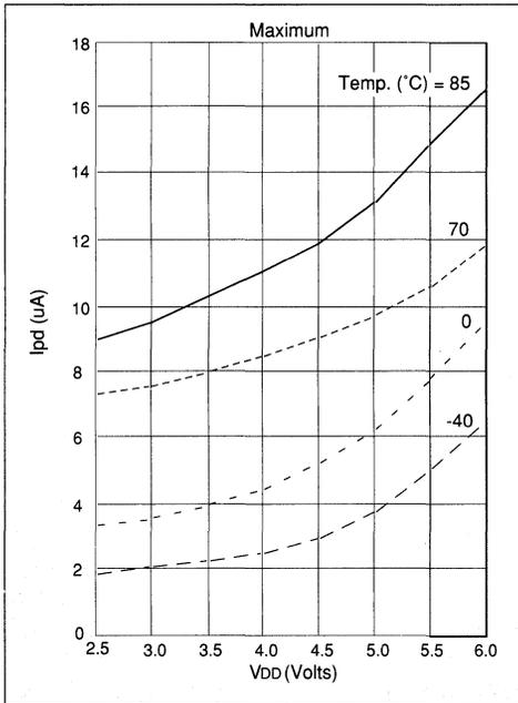
**FIGURE 9.0.8 - MAXIMUM I<sub>pd</sub> vs V<sub>DD</sub>
