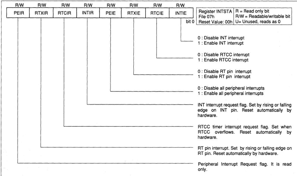
FIGURE 3.7.1.2: PIR (PERIPHERAL INTERRUPT REQUEST) REGISTER
