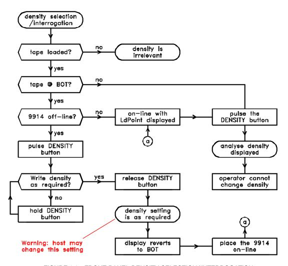
FIGURE 3.8 FRONT PANEL DENSITY SELECTION/INTERROGATION
