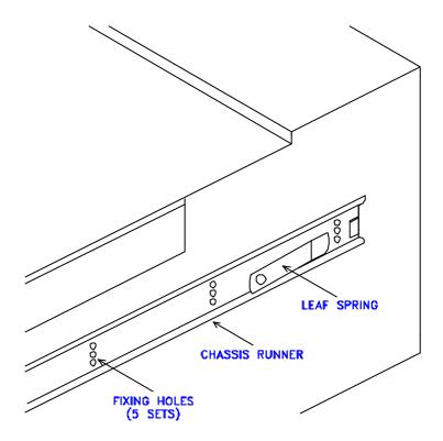
FIGURE 2.3.2 CHASSIS RUNNER ORIENTATION
