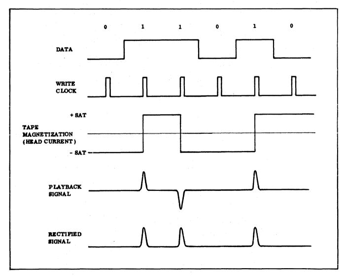
Figure 1-2. NRZ Waveforms
