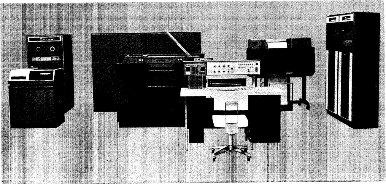
Figure 26. Disk-Storage-Oriented 1460 System
