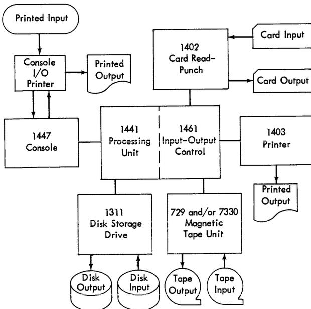
Figure 27. Disk-Storage-Oriented 1460 System Schematic
