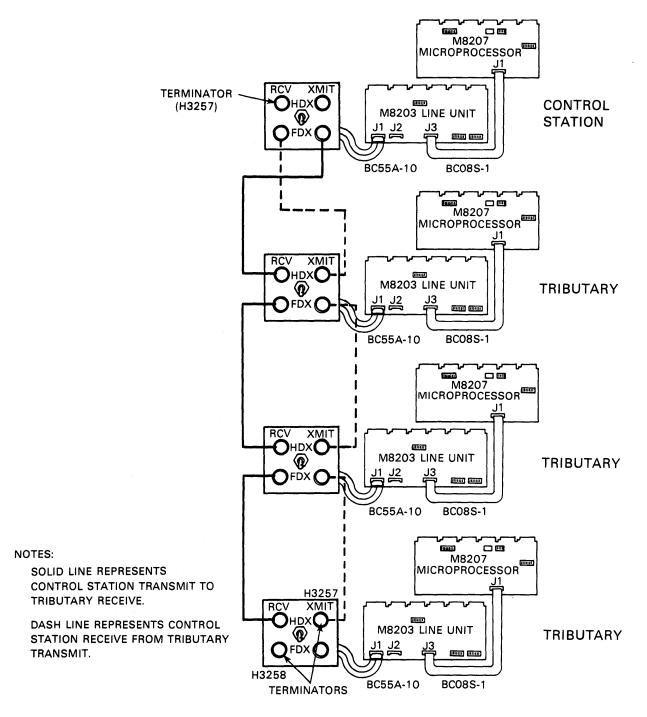
BOTH ENDS OF THE TRANSMIT LINE FROM THE TRIBUTARIES NEED TERMINATION IN ADDITION TO THE ONE TRANSMIT LINE FROM THE CONTROL STATION
