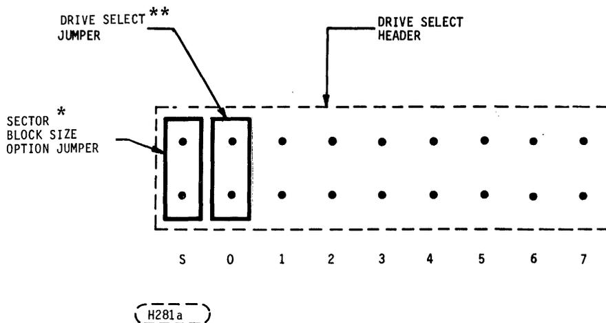
FIGURE 13. WREN II SCSI ID SELECT & BLOCK SIZE JUMPERS
