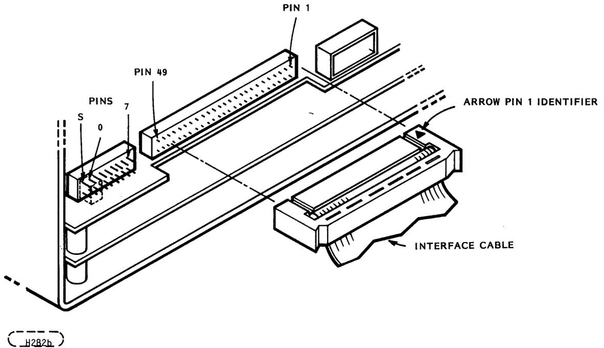
FIGURE 10. CABLE CONNECTION
