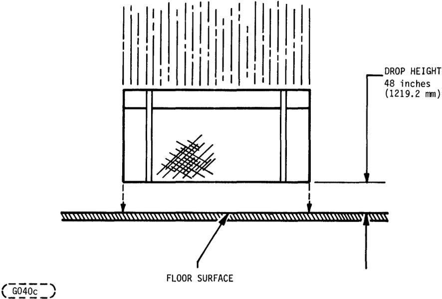
FIGURE 6. FLAT DROP TEST
