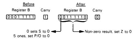
SLA (HL) — SHIFT CONTENTS OF MEMORY LOCATION SLA (IX+disp) LEFT ARITHMETIC SLA (IY+disp)
