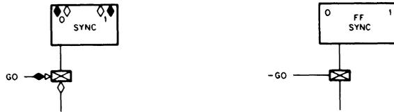
Figure 3-8 Trailing Edge Triggering
