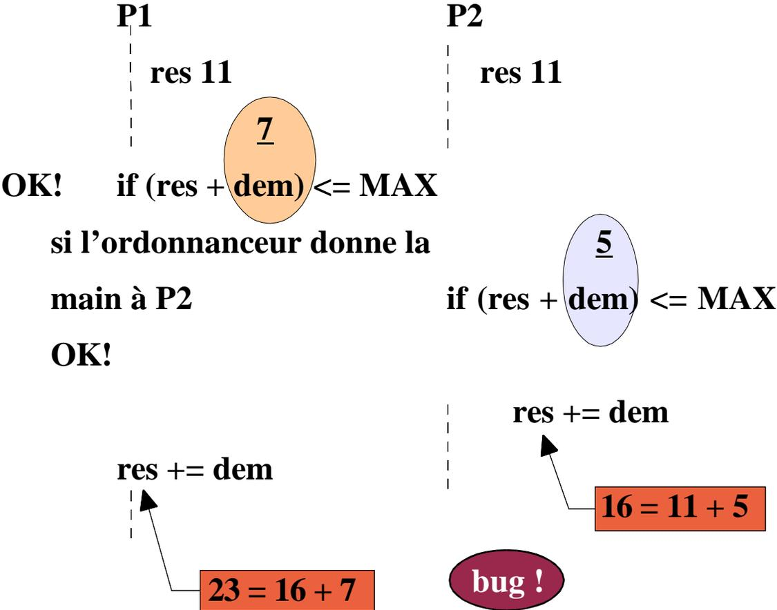
On s'aperçoit qu'éliminer les cas divergeant revient à rendre **indivisible (atomique)** la séquence de plusieurs tâches dans le graphe de précedence.
