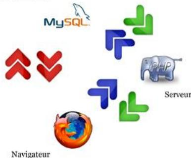
Les flèches bleues représentent les flux de données qui transitent depuis l'internaute jusqu'à la base de données et les flèches vertes les données transitant depuis la base de données jusqu'au navigateur de l'internaute. Ces transferts de données sont schématisés par les flèches rouges.
