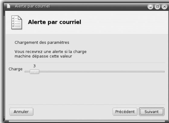
Figure 10.30 : Fixation du seuil de charge système déclenchant l'envoi d'un e-mail
