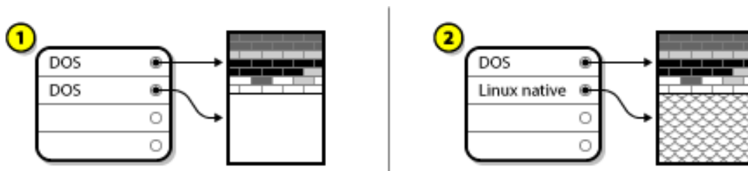
Figure A.13. Disque dur avec configuration de partition finale
