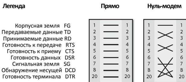
Рис. 31.2. Разводки контактов и схемы соединения кабелей для разъемов DB-25
