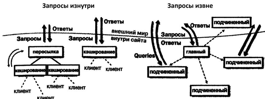
Рис. 17.2. Архитектура сервера DNS
