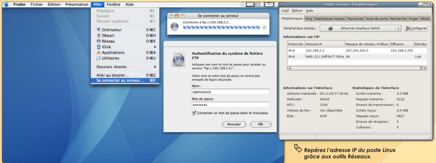
Le menu Aller > Se connecter au serveur, sert à établir la communication entre Mac et Linux.
