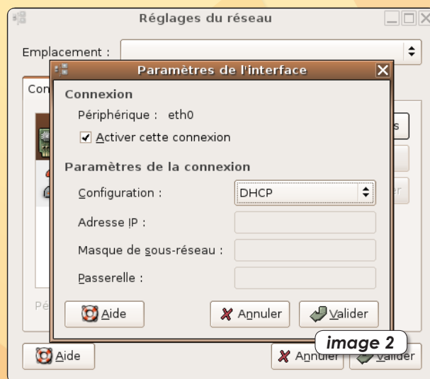
La fenêtre des Propriétés permet d'activer la connexion par Ethernet et de choisir une configuration DHCP.
