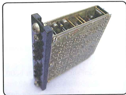
Fig 3 : Les CDC 6600 et 7600 étaient construits avec un assemblage de modules enfichables tels que celui-ci. On atteignait une très grande densité pour l'époque.
