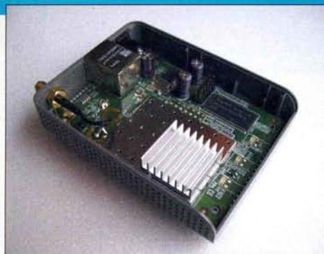
Le routeur Wifi La Fonera intègre une distribution GNU/Linux pour l'embarqué appelée « OpenWRT », un projet en logiciel libre largement documenté et disposant d'une communauté de développeurs très active.
