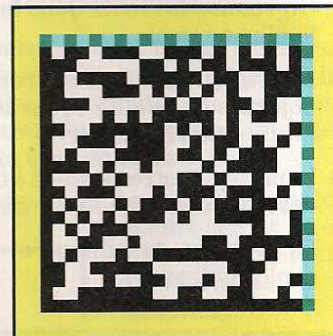
Les différentes zones d'un code-barres Datamatrix. En jaune, la quiet zone (marge de sécurité), en bleu, l'indicateur de densité, en noir opposé au bleu, le repère d'orientation et, au centre, les données.
