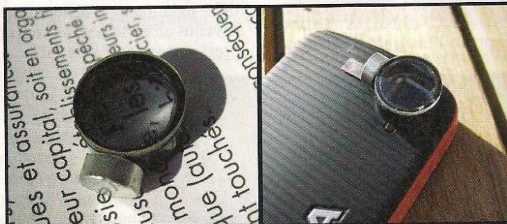
Les appareils photo numériques intégrés aux mobiles ne permettent pas les prises de vue en macro. L'ajout d'une lentille (une loupe) achetée en ligne ou « faite maison » permet de corriger le problème. Ici, une lentille provenant d'un télescope, adaptée à l'aide d'une attache magnétique amovible.
