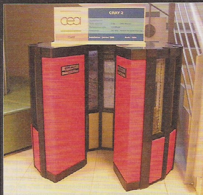
Figure 5b : Cray 2 : 4 CPU, 1,9 GFLOPS@240Mhz, introduit en 1985, exploité entre 1990 et 1994
