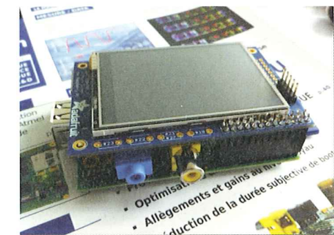
Fig. 2 : Écran monté et installé sur la carte
