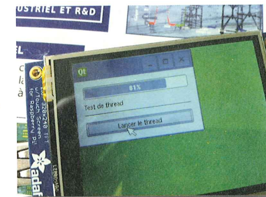
Fig. 14 : Application Qthread_ex sur RPi
