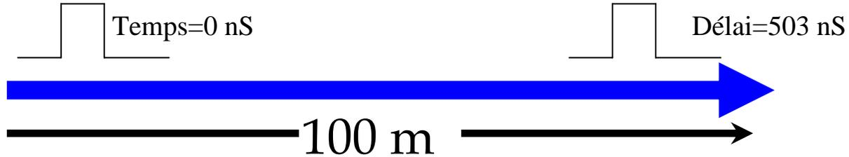
NVP (Nominal Velocity of Propagation) est la vitesse que met un signal à traverser un câble par rapport à la vitesse de la lumière dans le vide célérité. NVP est exprimé un % de la célérité: exemple 72% ou  $0.72c$ .
