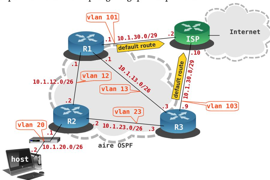
Cette topologie reprend très exactement la disposition en triangle présentée dans le support [Routage dynamique avec OSPF](#)<sup>7</sup>. L'utilisation du routage inter-VLAN sert à mettre en évidence la dissociation entre une topologie physique en étoile issue des définitions de la technologie Ethernet et une topologie logique en triangle dans laquelle chaque routeur doit apprendre au moins un réseau via ses voisins.
