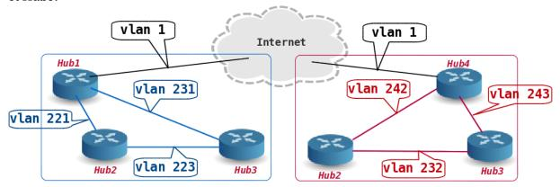
Les quatre sous-topologies WAN reprennent l'architecture étudiée dans le support Topologie Hub & Spoke avec le protocole PPP. La différence ici réside dans l'utilisation du protocole de routage dynamique OSPF sur des les liens WAN point à point.
