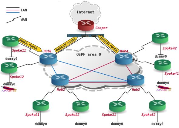
Les deux sous-topologies LAN reprennent l'architecture étudiée dans le support Routage dynamique avec OSPF. La seule particularité ici réside dans la redondance de deux VLANs entre les routeurs Hub2 et Hub3.
