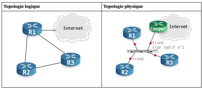
Après avoir mis en œuvre la topologie physique en s'appuyant sur le support de la séance de travaux pratiques précédente : Routage Inter-VLAN, on implante les démons de routage OSPF sur les trois routeurs R1, R2 et R3.
