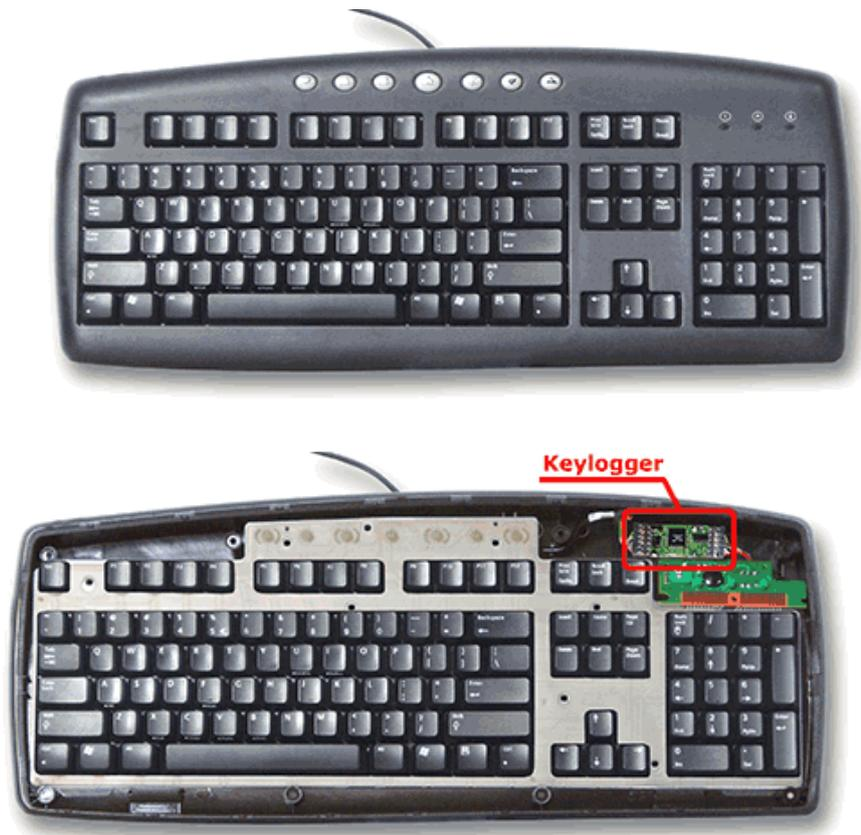
Le montage nécessite juste de réaliser 2x4 soudures pour intercaler la carte entre le clavier et le PC. Les keylogger de ce fournisseur sont très aboutis, puisqu'ils prennent en compte les layouts des différents pays, enregistrent les touches spéciales etc...
