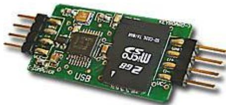
L'entreprise fournit aussi les spécifications d'un keylogger matériel « open-source », avec la liste des éléments électroniques qui le composent, le schéma électronique ainsi que le code assembleur pour le microcontrôleur.
