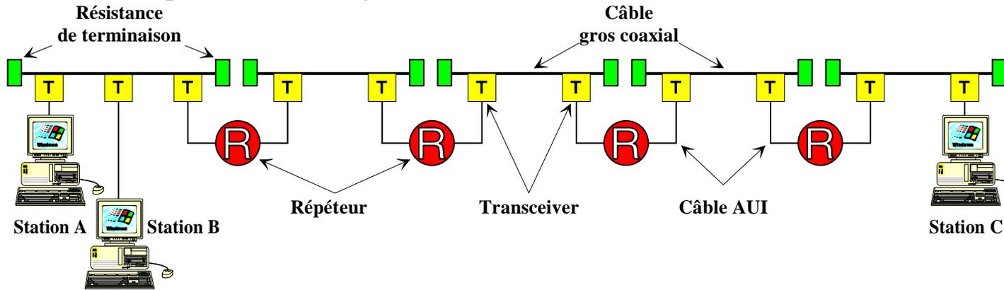
Supposons que la station A émette une trame à l'attention de la station B. La trame se propage d'abord jusqu'à la station B, celle-ci commence donc à la recevoir.
