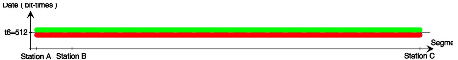
Ce deuxième cas est le plus favorable à une bonne détection des collisions. Il faut donc que la durée d'émission d'une trame soit toujours supérieure au temps maximum que celle-ci mettra pour se propager sur le réseau d'une extrémité à l'autre, plus le temps que mettra un JAM émis par la station d'extrémité pour parcourir l'ensemble du réseau. Cette durée correspond, par définition, au RTD (Round Trip Delay ), qui pour valeur 512 bit-times.
