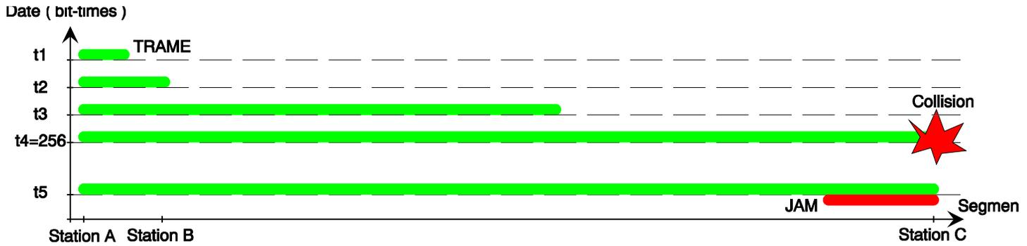
La station C détecte une immédiatement une collision et émet un JAM. Ce renforcement de collision se propage le long du réseau et arrive au niveau de la station B et de la station A.
