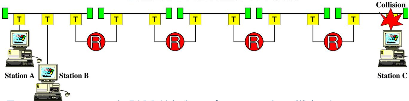
Temps que va mettre le JAM ( bit de renforcement de collision ) pour se propager d'une station d'extrémité ( Station C ) à l'autre ( station B ), afin de d'informer l'ensemble des stations.
