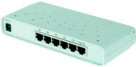
Cet équipement agit au niveau 1 du modèle OSI. Sa fonction est d'interconnecter plusieurs cartes d'interfaces ensemble. Ainsi, chaque signal électrique reçu est rediffusé sur tous les autres ports du HUB.
