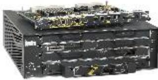
Cet équipement agit au niveau 3 du modèle OSI. Il permet de relier plusieurs réseaux IP différents. Pour cela, lorsqu'il reçoit une trame, il compare l'adresse IP destination du datagramme avec sa table de routage et route ce datagramme sur l'interface de sortie correspondante.
