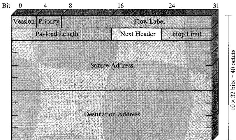
FIGURE 16.16 IPv6 header.
