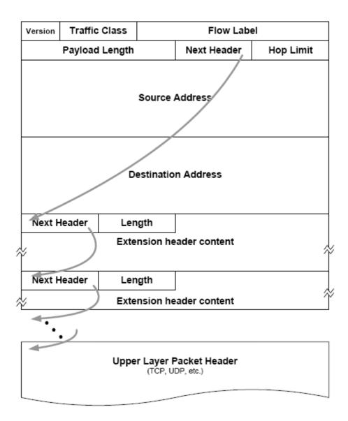
Figure 3-9. IPv6 Extension Header Chaining<sup>9</sup>
