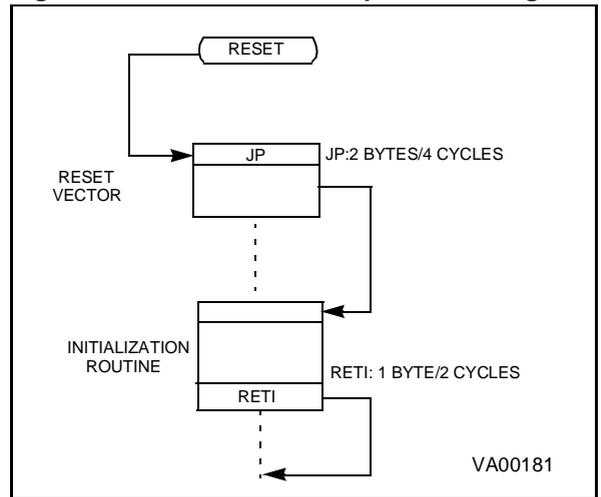
**Figure 16. Reset Block Diagram**
