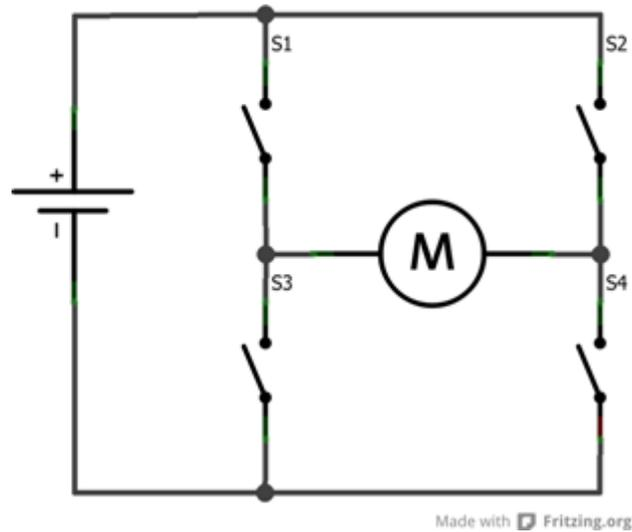
Eh bien, cela change tout ! Car à présent nous allons piloter le moteur dans les deux sens de rotation. Pour comprendre le fonctionnement de ce pont en H (appelé ainsi par sa forme), imaginons que je ferme les transistors 1 et 4 en laissant ouverts le 2 et le 3. Le courant passe de la gauche vers la droite.
