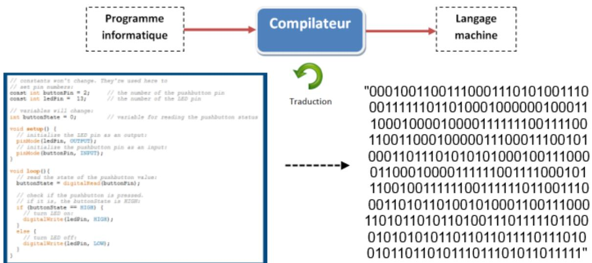
Au départ, le programme est sous forme de texte, puis il est transformé en un langage composé uniquement de 0 et de 1 (ce qui est absolument illisible en soi ! 😊).
