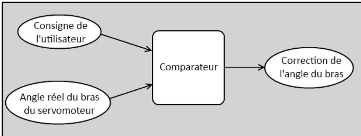
Synoptique de fonctionnement de l'asservissement du servomoteur
