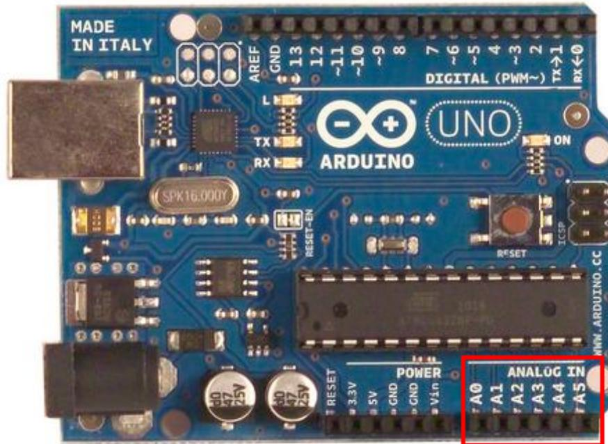
Ces 6 entrées analogiques sont numérotées, tout comme les entrées/sorties logiques. Par exemple, pour aller lire la valeur en sortie d'un capteur branché sur le convertisseur de la broche analogique numéro 3, on fera : `valeur = analogRead(3);`.
