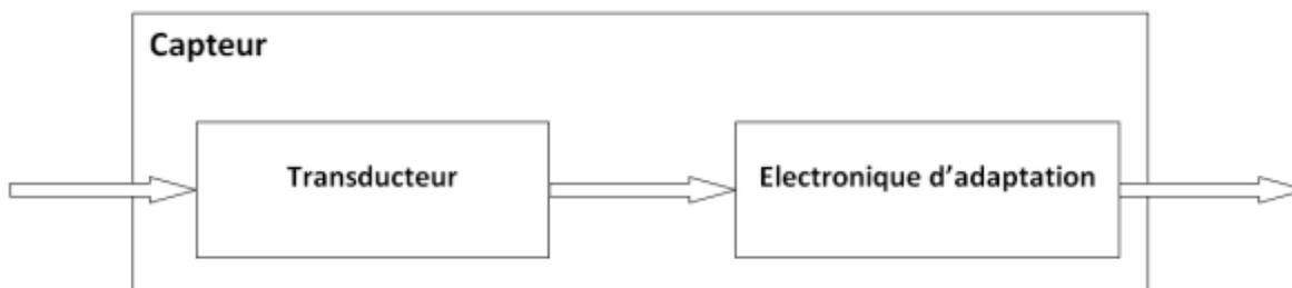
A gauche se trouve la grandeur physique mesurable. En sortie du transducteur c'est une autre grandeur physique, manipulable cette fois. Et en sortie de l'électronique d'adaptation, c'est l'information qui peut être sous forme de signal électrique ou d'une simple image de la grandeur physique mesurée par une autre grandeur physique telle qu'une tension électrique ou un courant.
