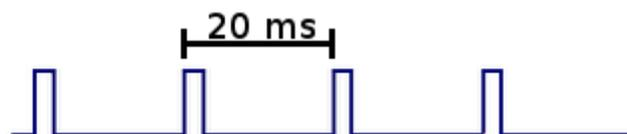
Malheureusement, la fonction `analogWrite()` de Arduino ne possède pas une fréquence de 50Hz, mais dix fois plus élevée, de 500Hz environ. On ne pourra donc pas utiliser cette fonction.
