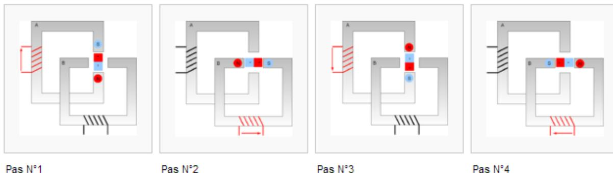
En rouge la bobine alimentée ainsi que le sens du courant symbolisé par une flèche et en noir la bobine qui n'est pas alimentée.
