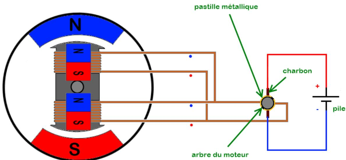
Ce champ va être opposé aux deux aimants permanents du stator du moteur, cela va donc mettre en mouvement l'axe du rotor. Et ce mouvement est défini par le fait que deux aimants orientés par leurs pôles opposés (face nord de l'un face au nord du deuxième, idem pour le sud) se repoussent. Par conséquent, l'axe du moteur, je le disais, va se mettre à tourner jusqu'à ce que les aimants permanents du stator se retrouvent face à chacun de leur complément créé par le champ magnétique des bobines :
