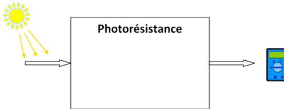
On a donc, en sortie du transducteur, une relation du type  $y = f(x)$ . Il s'agit simplement du **rapport** entre la grandeur physique d'entrée du capteur et sa grandeur physique de sortie. Ici, le rapport entre la luminosité et la résistance électrique de sortie. Dans les docs techniques, vous trouverez toujours ce rapport exprimé sous forme graphique (on appelle ça une **courbe caractéristique**). Ici, nous avons donc la résistance en fonction de la lumière :
