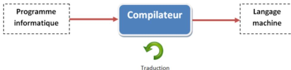
Donc, pour traduire le langage texte vers le langage machine (avec des 0 et des 1), nous aurons besoin de ce fameux compilateur. Et pas n'importe lequel, il faut celui qui soit capable de traduire le langage texte Arduino vers le langage machine Arduino. Et oui, sinon rien ne va fonctionner. Si vous mettez un traducteur Français vers Allemand entre notre patron anglais et son ouvrier chinois, ça ne fonctionnera pas mieux que s'ils discutaient directement. Vous comprenez ?
