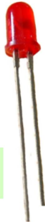
J'appellerai la diode électroluminescente, tout au long du cours, une LED. Une LED est en fait une **diode** qui émet de la lumière. Je vais donc vous parler du fonctionnement des diodes en même temps que celui des LED.
