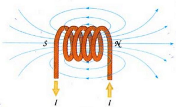
En somme, on retiendra que lorsque l'on crée une bobine de fil électrique, en général du cuivre, on additionne les champs magnétiques créés par chaque spire de la bobine. Ainsi, vous comprendrez aisément que plus la bobine contient de spires et plus le champ magnétique qu'elle induit est important. Je ne vous ai pas trop perdu, ça va pour le moment ? 😊 Bon, continuons.
