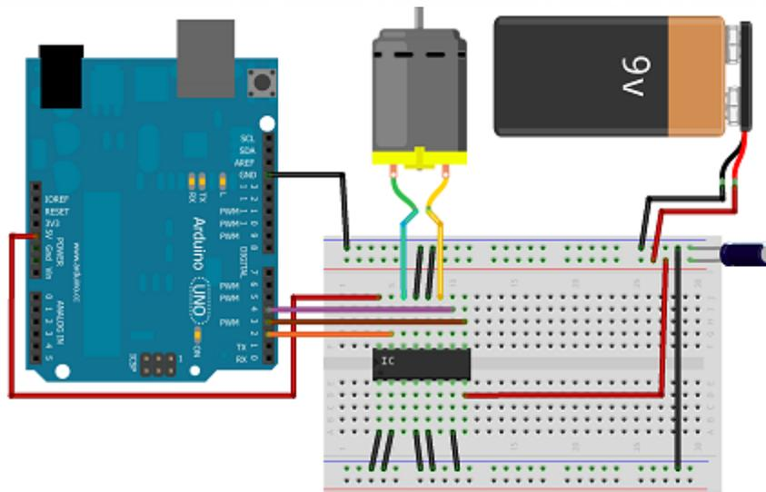
**Vous noterez la présence du gros condensateur polarisé (100  $\mu\text{F}$  / 25V ou plus selon l'alimentation) pour découpler l'alimentation de puissance du L293D.** Comme je n'utilise qu'un seul pont, j'ai relié à la masse les entrées de celui qui est inutilisé afin de ne pas avoir des entrées qui "grésillent" et fassent consommer le montage pour rien. Enfin, vous remarquez que j'utilise trois broches de l'Arduino, deux pour le sens (2 et 4) et une PWM pour la vitesse (3).
