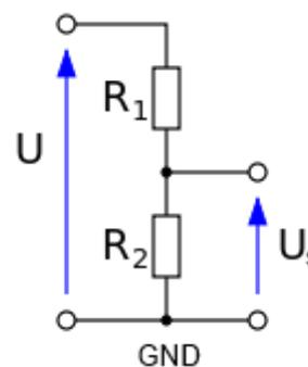
Libre à vous de modifier les valeurs des résistances du pont diviseur de tension pour faire rentrer des tensions différentes (même au delà de 10V !). Attention cependant à ne pas dépasser les +5V en sortie du pont !
