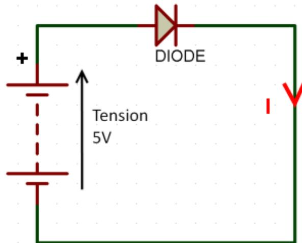
Figure 1 : diode polarisée directement
