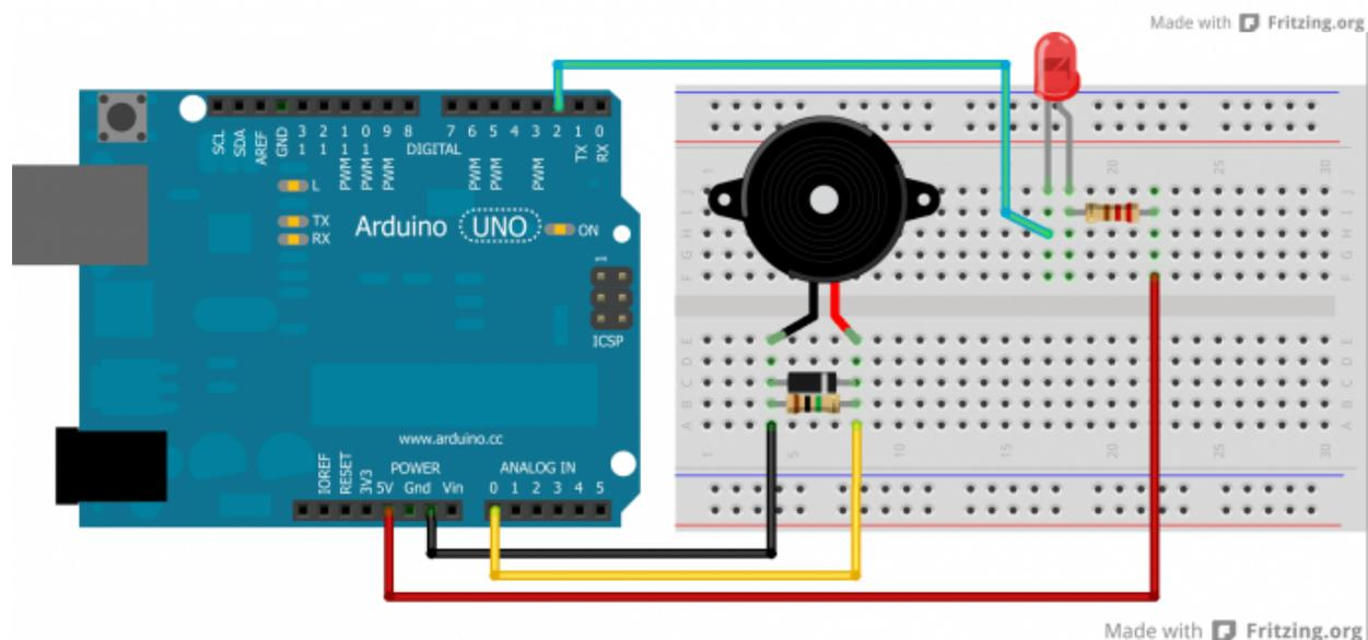
La résistance de  $1M\Omega$  en parallèle de l'élément piézoélectrique permet d'éviter les courants trop forts qui peuvent être générés par l'élément piézoélectrique. Il est accompagné par une diode un peu particulière que l'on appelle une diode zener. Cette dernière sert à éviter les surtensions. Si jamais la tension générée par le piezo dépasse son seuil (4.7V en l'occurrence), elle deviendra passante et le courant ira donc vers la
