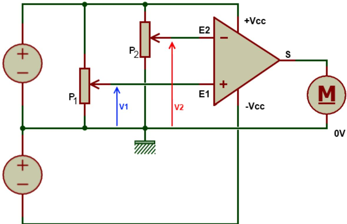
De gauche à droite on a : les alimentations qui fournissent la tension positive et négative ; les potentiomètres P1 et P2 ; le comparateur (oui c'est ce gros triangle avec un plus et un moins) : enfin le moteur à courant continu.
