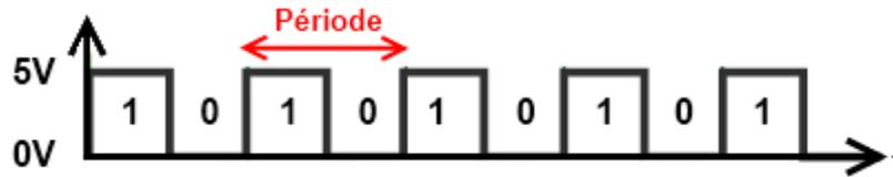
La période de ce signal est le motif qui se répète tant que le signal existe. Ici, c'est le niveau logique 1 et 0 qui forme le motif. Mais cela aurait pu être 1 1 et 0, ou bien 0 1 1, voir 0 0 1 1 1, les possibilités sont infinies ! Pour un signal analogique, il en va de même. Reprenons le signal de tout à l'heure :
