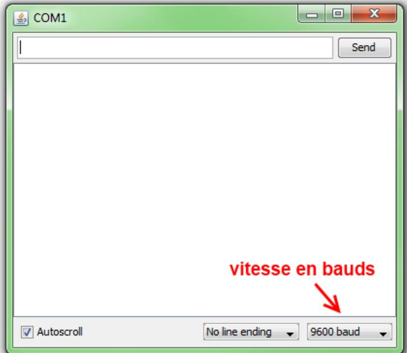
Dans cette fenêtre, vous allez pouvoir envoyer des messages sur la voie série de votre ordinateur (qui est émulée par l'Arduino) ; recevoir les messages que votre Arduino vous envoie ; et régler deux trois paramètres tels que la vitesse de communication avec l'Arduino et l'autoscroll qui fait défiler le texte automatiquement. On verra plus loin à quoi sert le dernier réglage.
