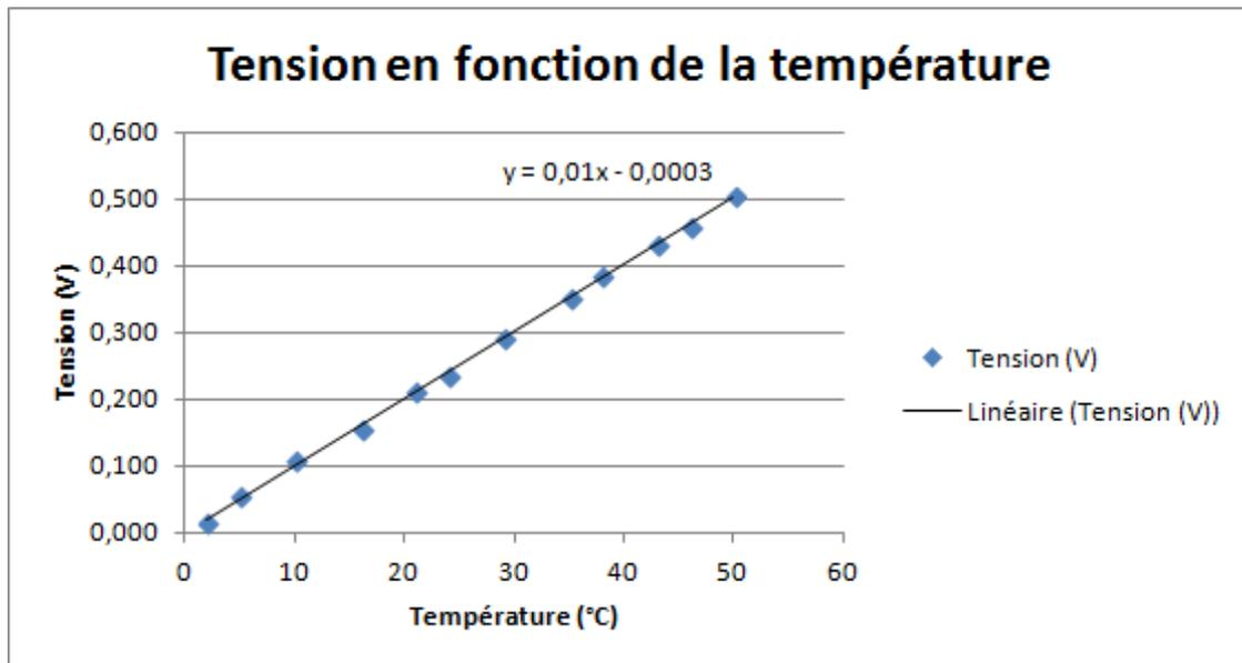
Grâce à l'équation, nous pouvons déterminer la relation liant la température et la tension (ou les valeurs du CAN). Ici nous obtenons :
