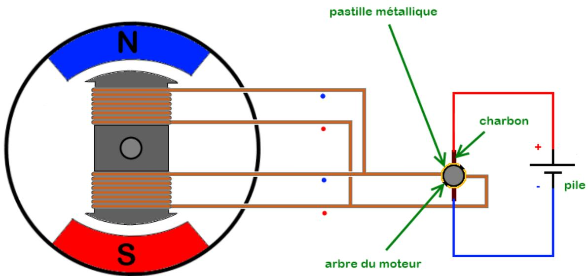
Dites-vous bien qu'il ne s'agit là que d'un schéma de principe simplifié, car je le disais, les moteurs n'ayant que deux bobines n'existent pas.
