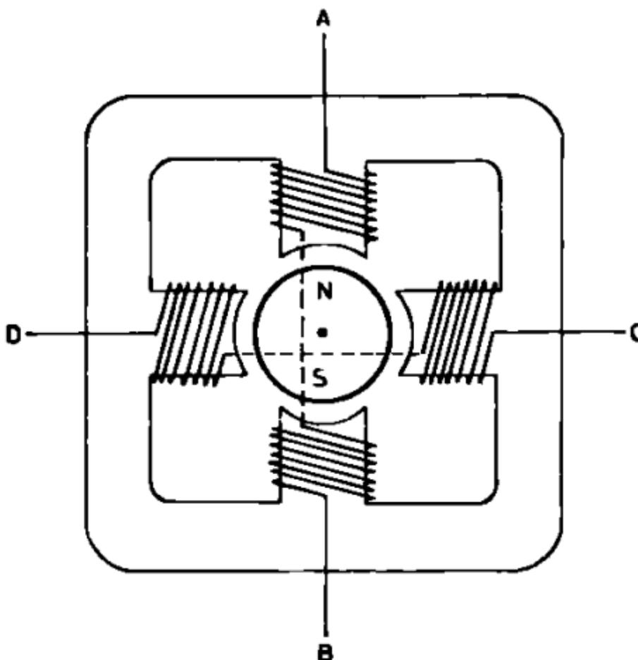
Vous l'aurez compris, les bobines sont reliées deux à deux en série et sont donc pilotés ensemble. Il n'y a donc finalement que deux enroulements à commander puisque deux bobines montées en série n'en font plus qu'une. Leur placement de part et d'autre de l'aimant permanent du rotor permet de piloter ce dernier. Voyons comment.
