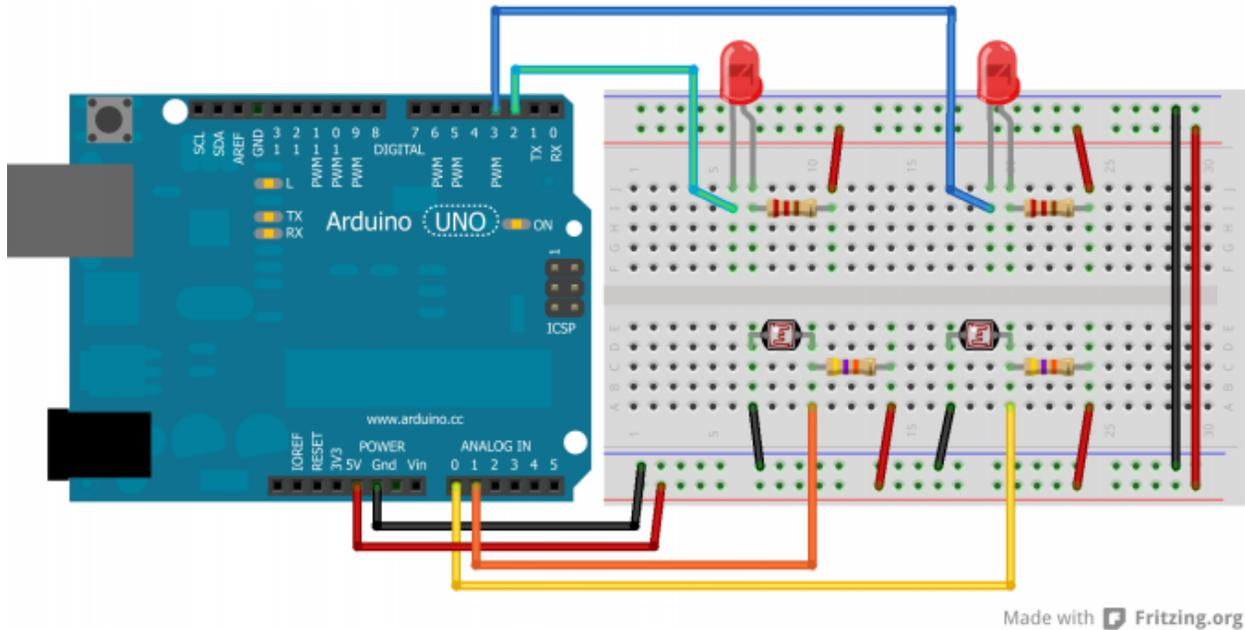
Si la valeur à droite est plus forte, on allumera une LED en broche 2. Sinon, on allume en broche 3. Si la différence est faible, on allume les deux. Dans tous les cas, il n'y a pas de cas intermédiaire. C'est soit à gauche, soit à droite (selon la disposition des photorésistances). Ce principe pourrait être appliqué à un petit robot mobile avec un comportement de papillon de nuit. Il cherche la source de lumière la plus intense à proximité.
