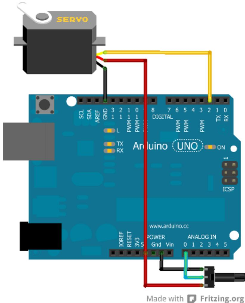
Pour ma part, j'ai branché le servo sur la broche numérique 2 et le potentiomètre sur la broche analogique 0. J'ai donc le code suivant pour préparer l'ensemble :
