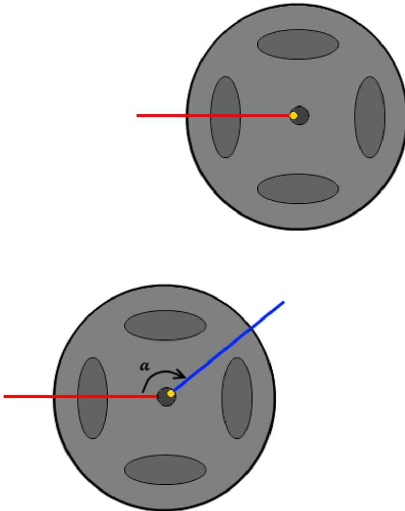
Marquage de l'axe du moteur par un point jaune (gauche). Au bout d'une seconde (droite), mesure de l'angle  $\alpha$  entre la position de départ et d'arrivée du point jaune. On obtient alors la vitesse de rotation de l'axe du moteur. Cette mesure est exprimée en angle par seconde.
