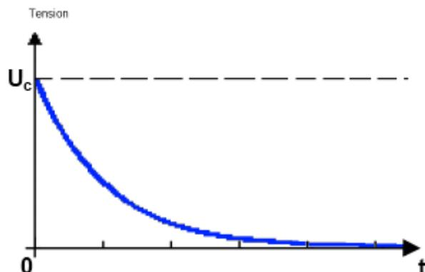
Pour terminer, on peut déterminer le temps de charge et de décharge du condensateur à partir d'un paramètre très simple, que voici :
