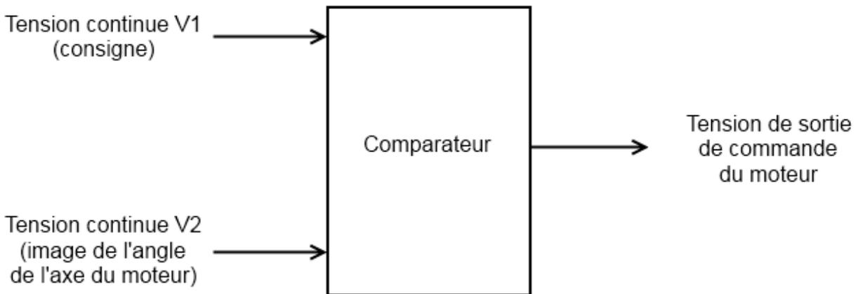
Il y a donc en entrée les deux paramètres : la consigne et l'angle réel de l'axe du moteur; Et en sortie, la tension qui va commander le moteur. On l'a vu, un moteur à courant continu doit être commandé par une tension continue, si cette tension est positive, le moteur tournera dans un sens, si elle est négative, le moteur tournera dans l'autre sens. C'est pourquoi le comparateur délivrera une tension positive ou négative selon la correction d'angle à effectuer.
