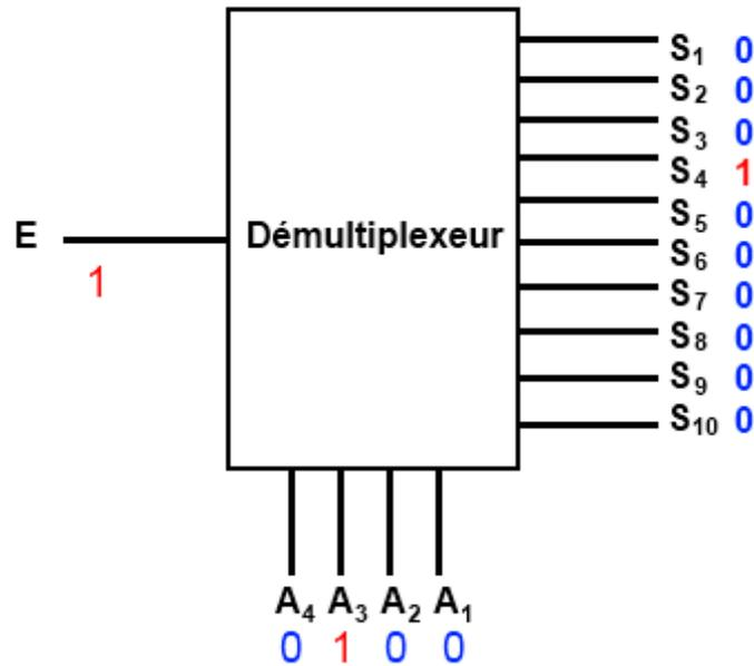
Je rappelle que, pour les entrées de sélection, le bit de poids fort est  $A_4$  et le bit de poids faible  $A_1$ . Idem pour les sorties,  $S_1$  est le bit de poids faible et  $S_{10}$ , le bit de poids fort.
