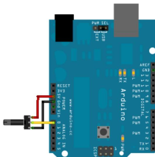
Une fois le raccordement fait, nous allons faire un petit programme pour tester cela. Ce programme va simplement effectuer une mesure de la tension obtenue sur le
