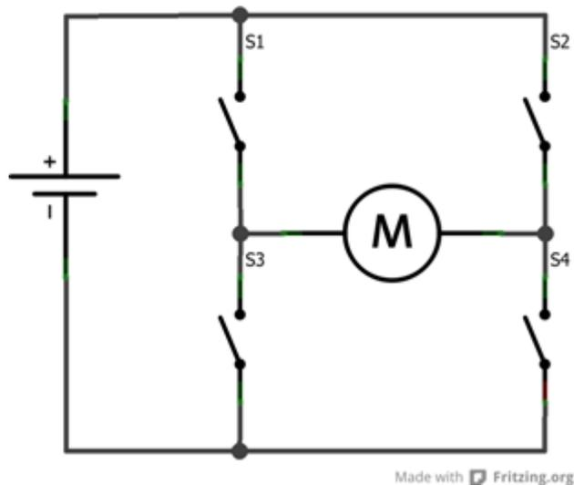
Problème, un pont en H ne peut piloter qu'une "paire de bobine" (celle qui sont dans le même axe et relié entre elles), hors nous en avons deux à piloter. Heureusement le L298 est un composant très bien pensé et ne possède non pas un mais bien deux ponts en H ! Du coup, nous pourrons en utiliser un par couple de bobine 😊 . Plutôt sympa non ?
