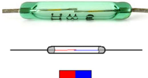
Dès que l'on approche un aimant, à partir d'un certain seuil de champ magnétique, le capteur agit. Il devient alors un contact fermé et reprend sa position de repos, contact NO, dès que l'on retire le champ magnétique. Ce type de capteur est très utilisé en sécurité dans les alarmes de maison. On les trouve essentiellement au niveau des portes et fenêtres pour détecter leur ouverture.
