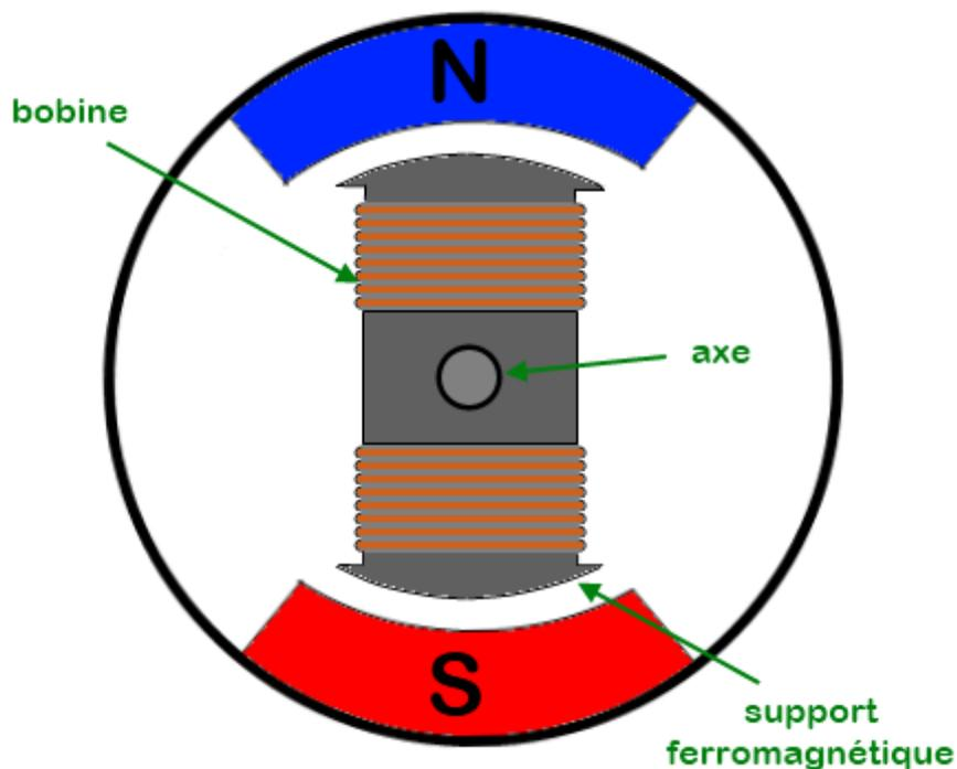
Il s'agit bien d'un schéma de principe, normalement un moteur à courant continu est constitué de trois bobines sur son rotor. Autrement on pourrait obtenir un équilibre qui empêcherait la rotation de l'arbre du moteur, mais surtout le moteur tournerait dans un sens aléatoire. Ce qui n'est pas très adapté quand on veut faire avancer son robot. 🤖
