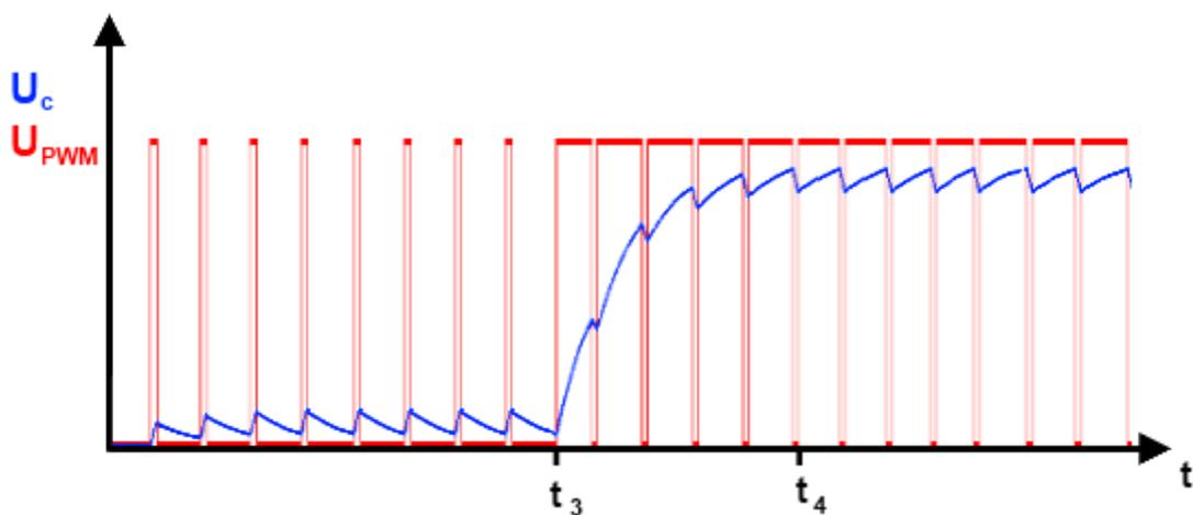
Pour une constante de temps identique pour chaque courbe réalisée, on relève que le temps de stabilisation du signal est plus rapide sur le chronogramme où la fréquence est deux fois plus élevée qu'avec la fréquence standard d'Arduino. Ici donc, on a :  $t_2 - t_1 = 2 \times (t_4 - t_3)$  . En effet car le temps (T) est proportionnel à la fréquence (F)
