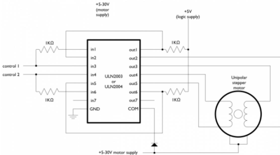
(source des images : [tigoe.net](http://tigoe.net)) Cette solution est plutôt intéressante du fait que les entrées/sorties sont parfois une denrée rare sur Arduino ! 🇩🇪
