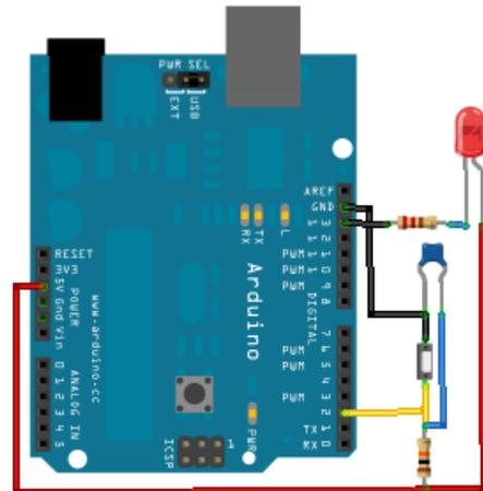
Montage simple avec un bouton et une LED
