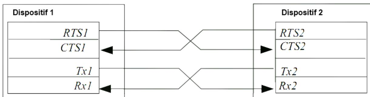
Voilà le branchement adéquat pour utiliser ce contrôle de flux matériel à 5 fils. Une transmission s'effectue de la manière suivante :
