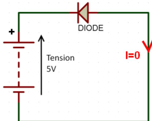
Figure 2 : diode polarisée en inverse
