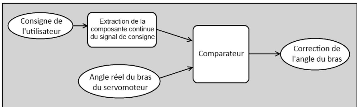
Le schéma électrique ne change pas non plus de beaucoup, on retire le potentiomètre qui permettait de régler la consigne manuellement en le remplaçant par le montage qui fait l'extraction de la composante continue:
