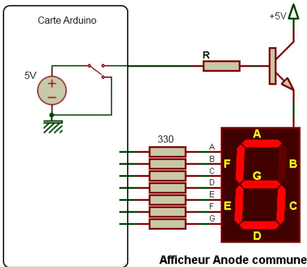
LA carte Arduino va soit mettre à la masse la base du transistor, soit la mettre à +5V. Dans le premier cas, il sera bloqué et l'afficheur sera éteint, dans le second il sera saturé et l'afficheur allumé. Il en est de même pour chaque broche de l'afficheur. Elles
