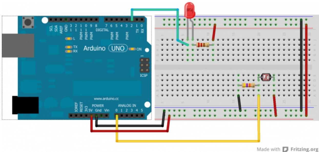
On calibre le pont diviseur de tension de manière à ce qu'il soit "équitable" et divise la tension d'alimentation par 2 en sa sortie. Ainsi, lorsque la luminosité fluctuera, on pourra mesurer ces variations avec la carte Arduino. Avec ce montage, **plus l'intensité lumineuse est élevée, plus la tension en sortie du pont sera élevée** à son tour. Et inversement, plus il fait sombre, moins la tension est élevée.
