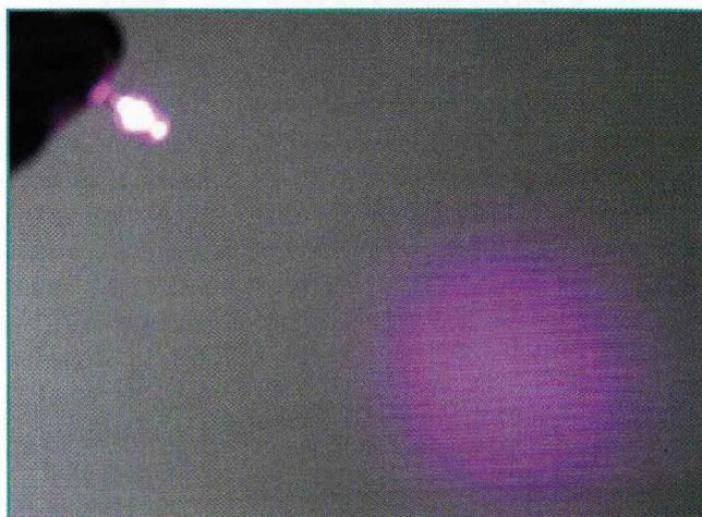
Figure 1 : Une LED en boîtier 5mm est assez directive pour créer un petit halo.
