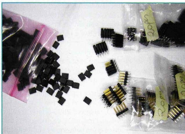
Figure 7 : les cavaliers, ou jumpers, permettent d'alimenter indépendamment chaque chaîne de 7 LED pour faciliter le réglage du motif.
