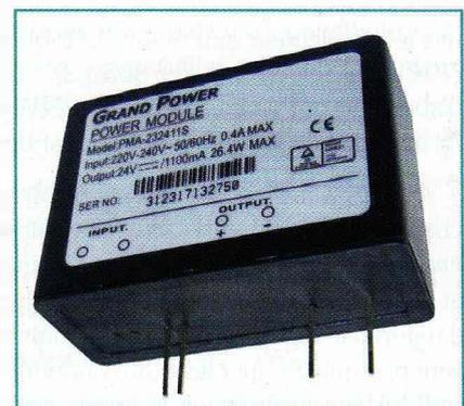
Figure 3 : Un module AC/DC compact
