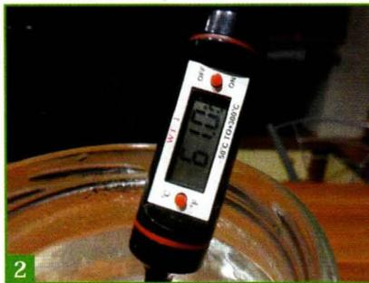
2 Pour modeler la PCL, il faut la chauffer à 60°C. Le plus simple et le moins risqué est alors d'utiliser de l'eau à cette température pour obtenir un réchauffement homogène.
