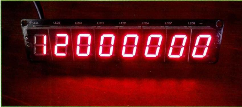
L'afficheur mis en œuvre repose sur l'utilisation de huit afficheurs leds 7 segments pilotés par des composants logiques chaînés, des 74hc595.
