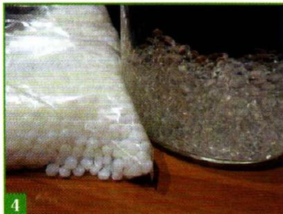
4 Après quelques dizaines de secondes seulement, la PCL est prête à être utilisée. On peut constater la différence de transparence avec les grains à température ambiante.
