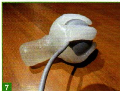
7 Ainsi, la webcam endommagée se voit équipée d'un support amovible solide. Notez la partie gauche, encore translucide car non entièrement refroidie.
