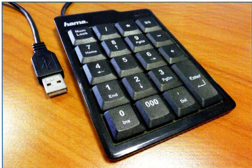
*En étudiant les périphériques via le système de gestion d'entrées de Linux, nous avons découvert en quoi un pavé numérique pour portable était différent d'un pavé numérique standard : il ne maintient pas NumLock activé en permanence, mais l'active avant chaque pression sur les touches et le désactive juste après le relâchement. Ceci évite de placer le clavier du laptop en mode numérique et il conserve alors son agencement (layout) normal.*
