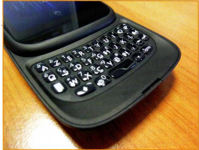
*Le Pre3 dispose d'un clavier mécanique. Troublant au premier abord avec ses touches molles et minuscules, il s'avère finalement relativement agréable et précis.*
