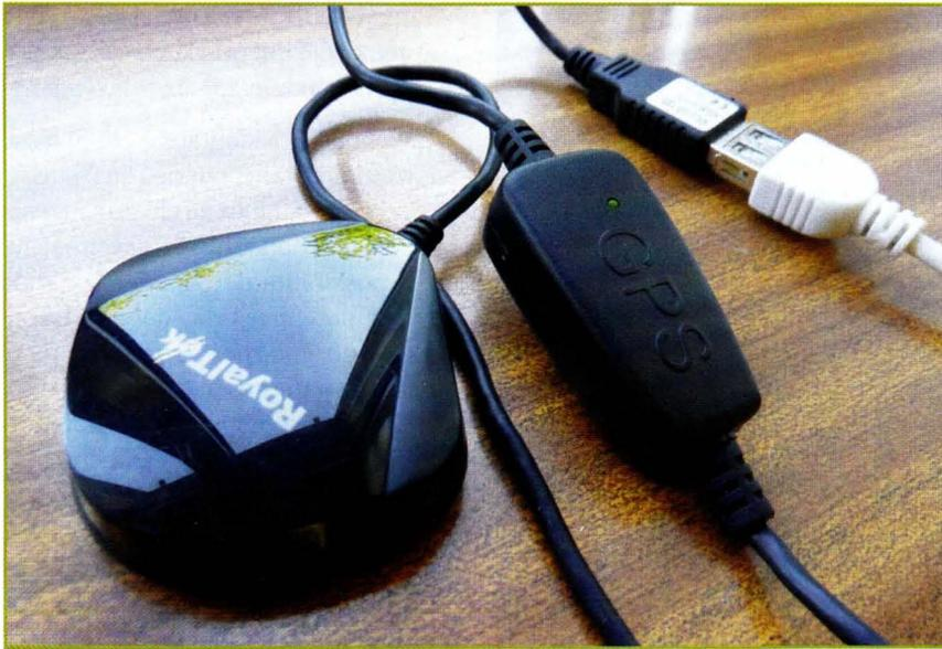
Voici un exemple typique de récepteur GPS USB tel qu'on en trouve un peu partout dans les boutiques en ligne. Généralement équipé d'un aimant permettant la fixation sur un toit de voiture, par exemple, il se résume à un récepteur couplé à un convertisseur USB/série communiquant à 4800 bps.
