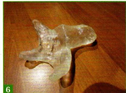
6 On modélera la forme souhaitée très facilement. Si la température baisse, il suffit de replonger l'ensemble dans l'eau à 60°C (et non, ceci n'est pas une patte de poulet).
