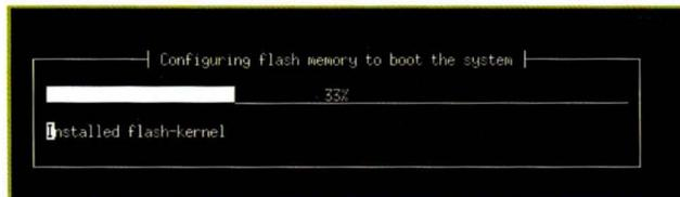
Le système d'installation Debian se charge, en fin de processus, de placer le noyau et l'image initramfs en mémoire flash.
