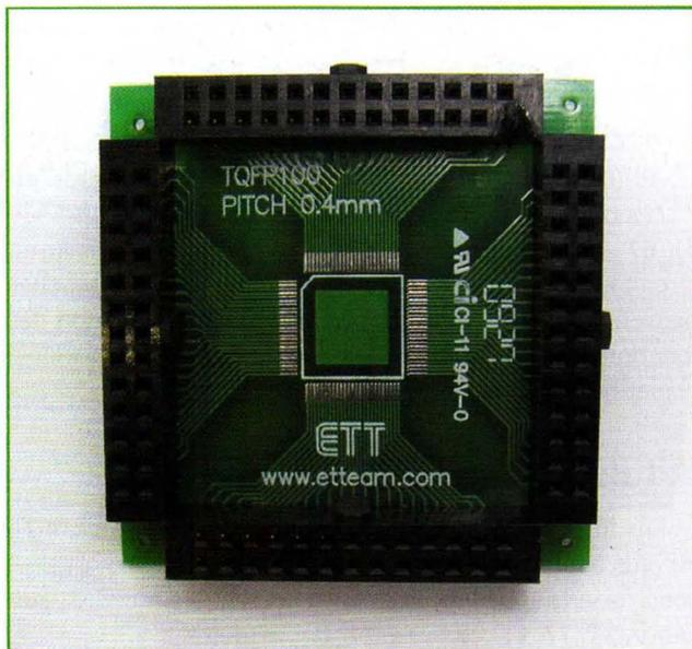
Figure 4 : L'adaptateur QFP100, côté verso, a maintenant des connecteurs femelles. Un détrompeur est aménagé au fer à souder en fondant le plastique près de la broche 100.
