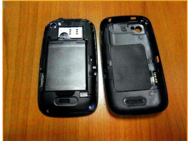
*L'ouverture de l'appareil nécessite un certain sang-froid. La coque arrière est, en effet, attachée par quelques clips. Les boutons au-dessus de l'appareil traversent la coque et ceux sur le côté sont mobiles. Bref, on a vraiment l'impression de tout casser en tentant l'opération et on souffle une fois l'appareil ouvert en espérant ne plus jamais avoir à recommencer.*
