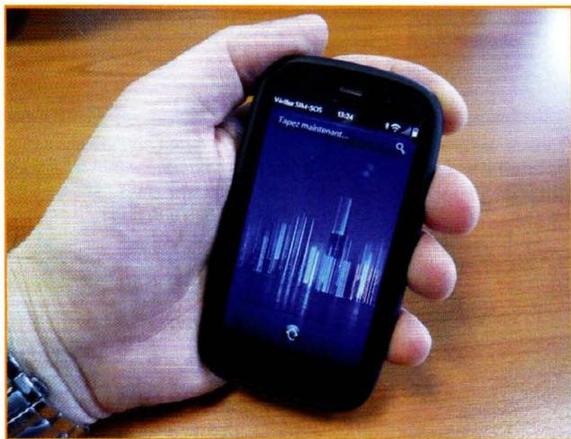
*Le HP Pre3, version « grand frère » du Veer. Un smartphone aux caractéristiques classiques mais utilisant un système d'exploitation basé sur GNU/Linux : WebOS 2.2. Ne le cherchez pas, l'arrêt de la fabrication des périphériques WebOS par HP a été annoncé quelques jours après la mise en vente de cet appareil.*
