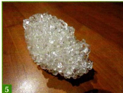
5 Une fois retirés de l'eau chaude, les grains ramollis se collent les uns aux autres et il devient possible de travailler la pâte pour en extraire l'eau et l'air.
