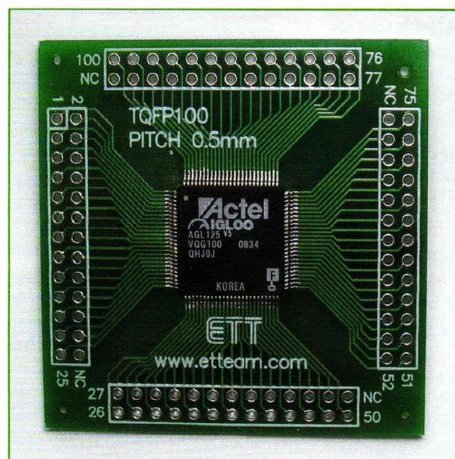
Figure 3 : La puce IGLOO en boîtier QFP100, soudée sur son support d'adaptation. Un peu plus lente que les ProAsic3, elle consomme aussi encore moins !
