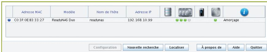
Netgear met à disposition un outil de monitoring et de configuration appelé RAIDar. En plus de permettre le paramétrage du matériel dans les premières phases d'installation, il offre également la possibilité de surveiller l'état des disques et des divers composants via UDP.
