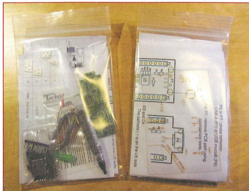
Figure 6 : Module GPIO-Demo en kit : PCB, composants, pochoir, étain en pâte et instructions
