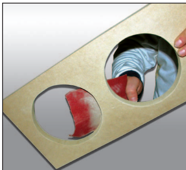
Figure 11 : Découpe des trois trous pour l'évent d'accord reflex et les haut-parleurs dans les panneaux de 174 x 310 et 460 x 210 (voir figure 10).
