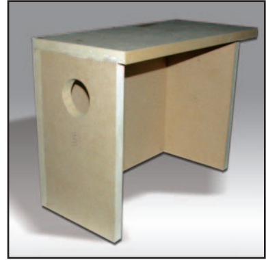
Figure 12: Les six panneaux sont assemblés par encollage des champs et vissage avec avant trous (voir figure 10).
