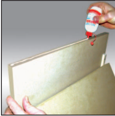
Figure 12: Les six panneaux sont assemblés par encollage des champs et vissage avec avant trous (voir figure 10).
