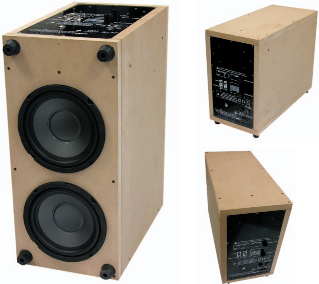
Figure 14 : Eh oui, ce sont bien quatre pieds d'appui en caoutchouc, en effet les haut-parleurs "regarderont" le carrelage (ou la moquette !) de votre auditorium ou de votre salon. Par conséquent le panneau arrière métallique se retrouvera vertical ; il sera traversé par le cordon secteur 230 V et recevra la BF de l'ampli. Voir encore figure 10.
