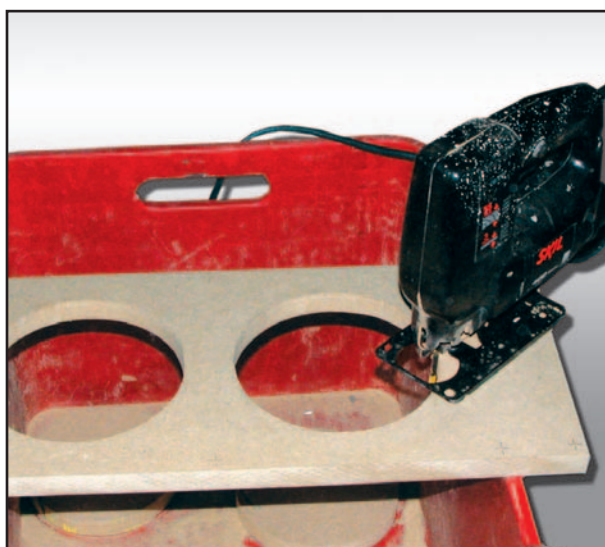
Figure 11 : Découpe des trois trous pour l'évent d'accord reflex et les haut-parleurs dans les panneaux de 174 x 310 et 460 x 210 (voir figure 10).
