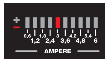
Figure 11: Si le multimètre indique 3 A et si vous tournez le trimmer R5 pour allumer DL5, les autres LED s'allument au pas de 0,6 A et la LD10 de fond d'échelle à 0,6 \times 10 = 6 A.
