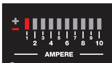
Figure 6: Si le multimètre indique 1 A et si vous tournez le trimmer R5 pour allumer DL1, la LED DL10 de fond d'échelle s'allume quand le courant est de 1 \times 10 = 10 A.
