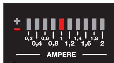
Figure 9: Si le multimètre indique 1 A et si vous tournez le trimmer R5 pour allumer DL5, la LED DL10 de fond d'échelle s'allume quand le courant est de 1 : 5 = 0,2 et 0,2 \times 10 = 2 A.
