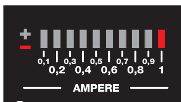
Figure 7: Si le multimètre indique 1 A et si vous tournez le trimmer R5 pour allumer DL10 de fond d'échelle, DL1 s'allume quand le courant est de 1 : 10 = 0,1 A.
