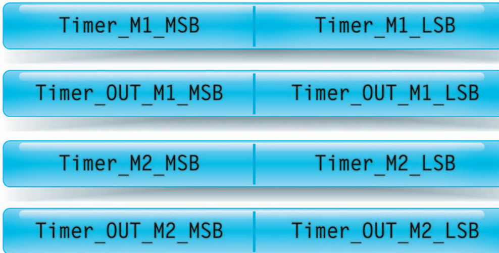
Figure 6 : La première variable contient la valeur instantanée de temps "t" et la seconde le temps maximal d'activation du moteur ; les deux premières lignes concernent M1, les deux suivantes M2.
